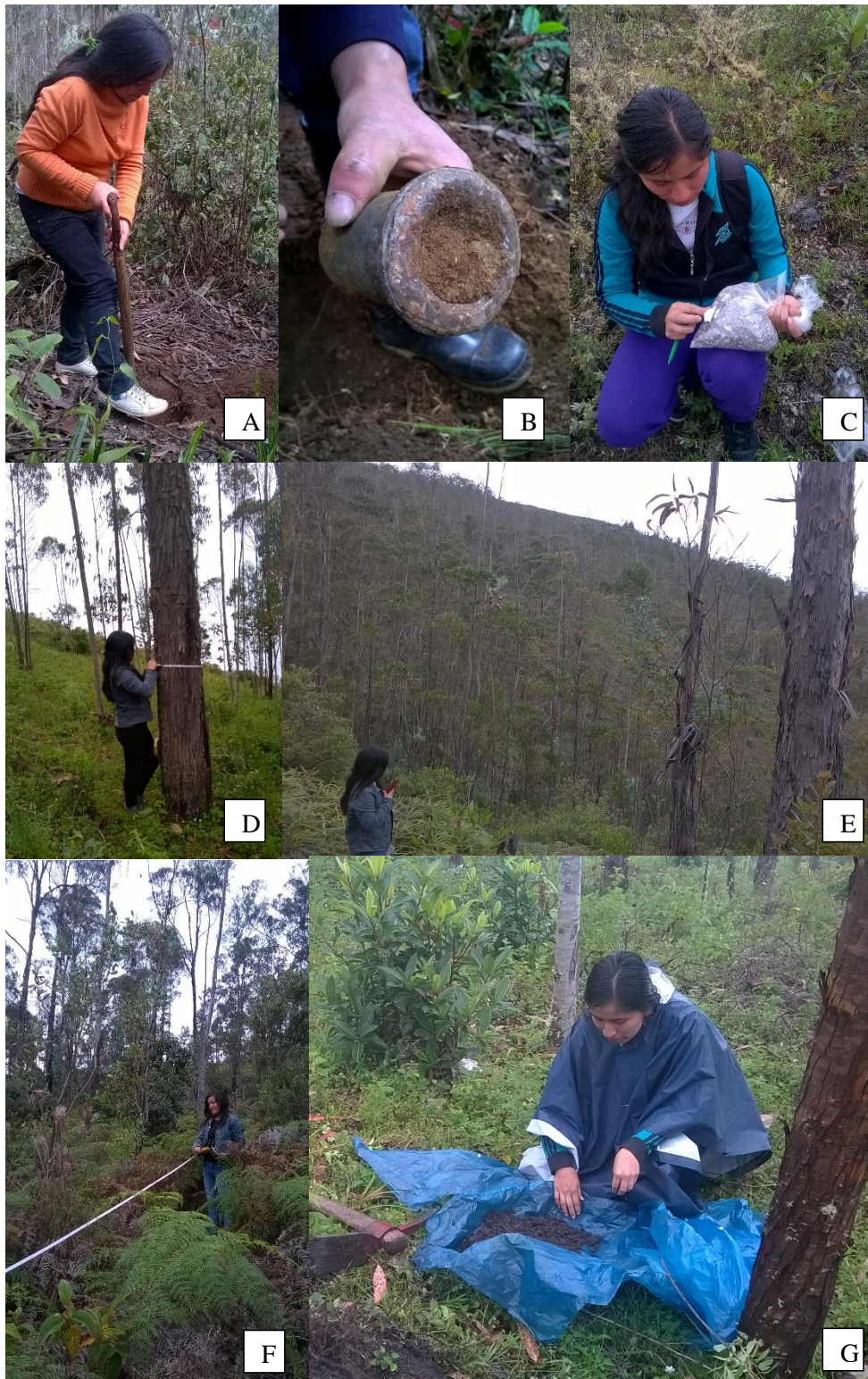
Fase de campo: (A) Extracción de muestras para su posterior análisis físico químico, (B) Extracción de muestras para calcular la densidad aparente, (C) Codificación de muestras, (D) Medida del DAP, (E) Medida de la altura de las plantas mediante un distanciómetro, (F) Medida de los cuadrantes para macrofauna, (G) Recolección de macrofauna.
