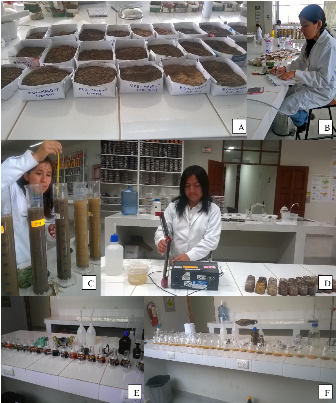
Fase de laboratorio: (A) Secado de muestras, (B) pesado de muestras, (C) Determinación de la clase textural, (D) Determinación de pH y conductividad eléctrica, (E) y (F) Determinación de carbono.
