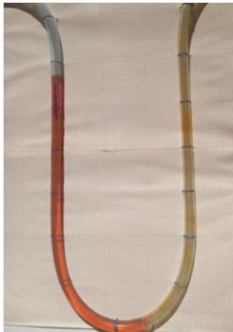
**Fotografía 7. Diferencias de altura en los manómetros para medir presión ejercida por el biogás.**
