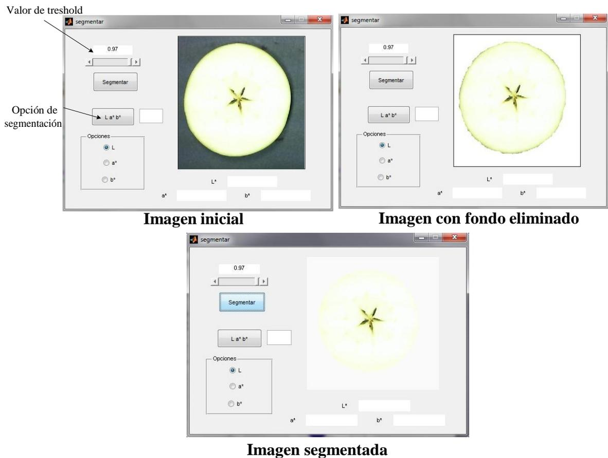
Figura 9. Resultado de la aplicación del algoritmo de segmentación
