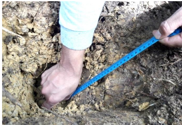
Figura 6. Muestreo de suelo a 30 cm de profundidad
