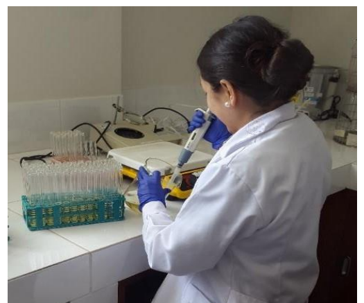
Figura 16. Preparación y siembra en los tubos con caldo Lauril Sulfato
