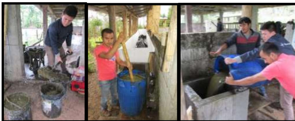
Figura 15. Mezcla estiércol:agua en la proporción 1:5 (1 balde de estiércol de 20 L con 5 baldes iguales de agua), preparada en un cilindro de 140 L; para cargar el biodigestor.
