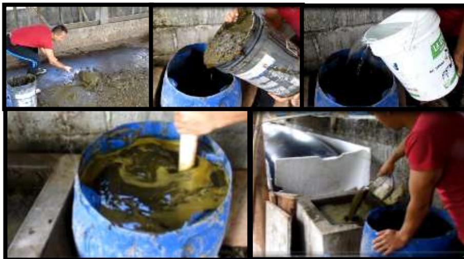
Figura 18. Alimentación del biodigestor.
