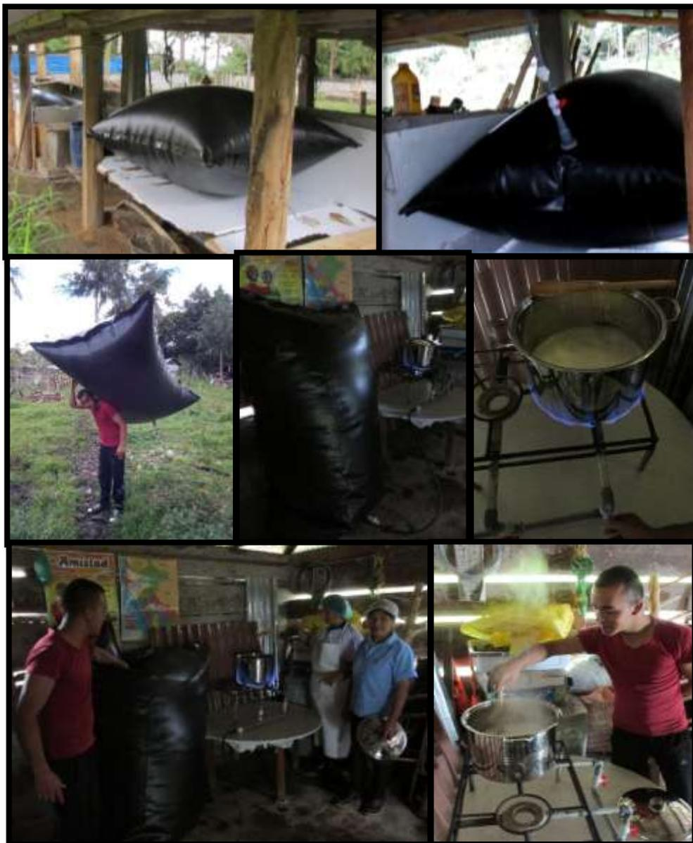
Figura 19. Prueba de combustión del biogas en la cocina para hervir leche endulzada.
