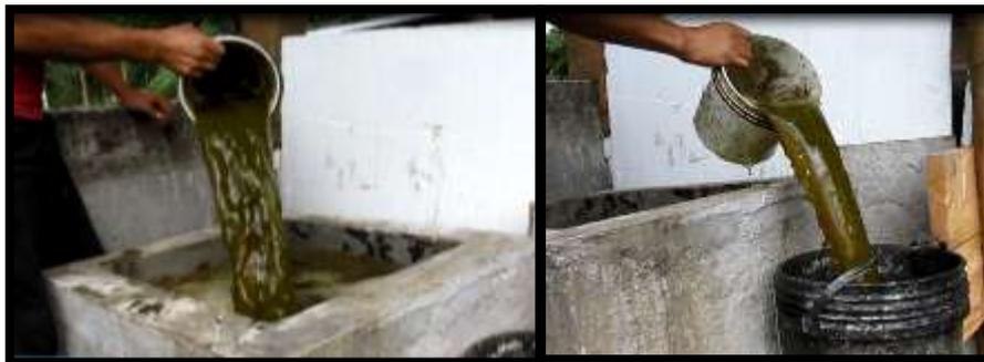
Figura 23. Retiro de biol de la poza de salida de biol del biodigestor.
