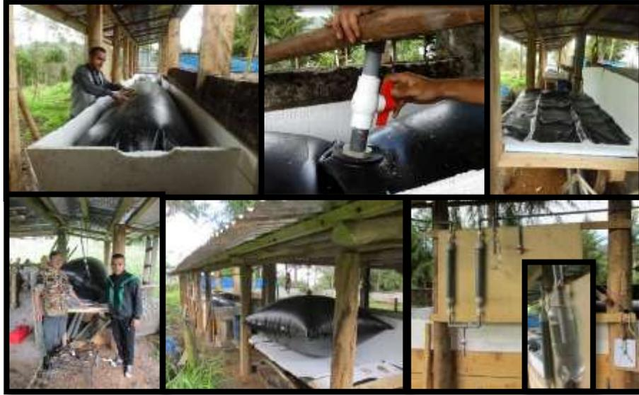
Figura 17. Trasvase de biogas del biodigestor al gasómetro.
