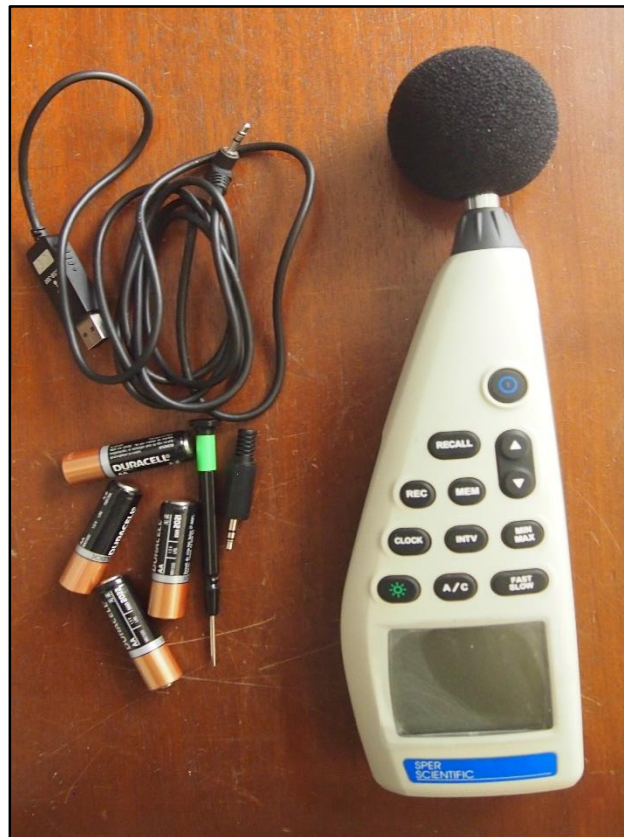
Figura 12: Sonómetro marca SPER SCIENTIFIC, modelo 850013, Tipo II, empleado para la evaluación de las fuentes móviles y fijas.
