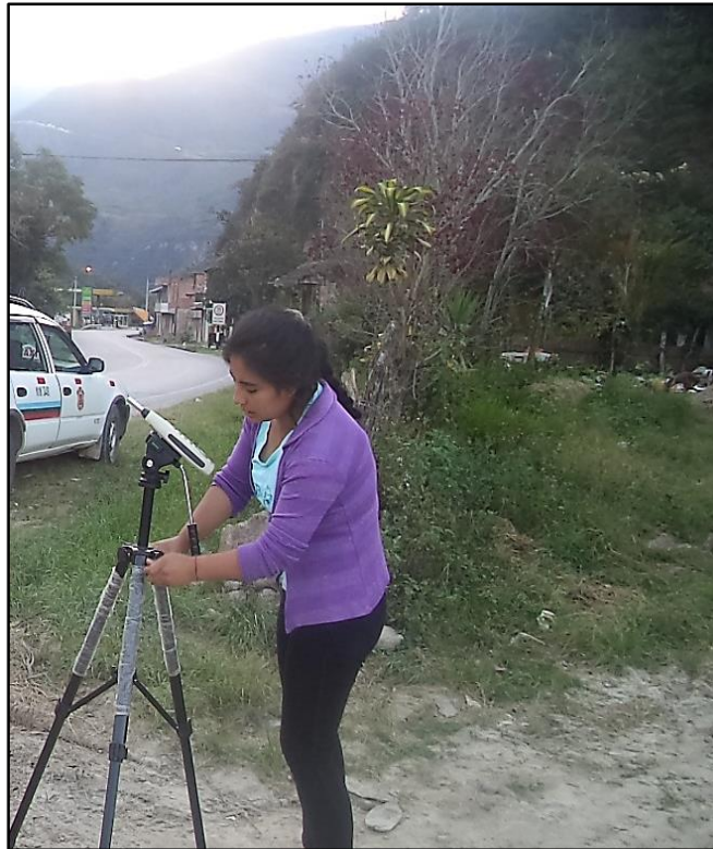
Figura 13: Instalación del sonómetro para la evaluación de ruido ambiental en el P 1 , ubicado en la Av. Cahuide cdra. 1.
