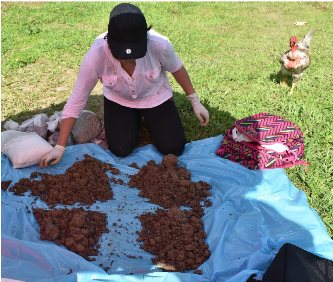
Anexo 27. Sistema de Cuarteo de las primeras 10 muestras
