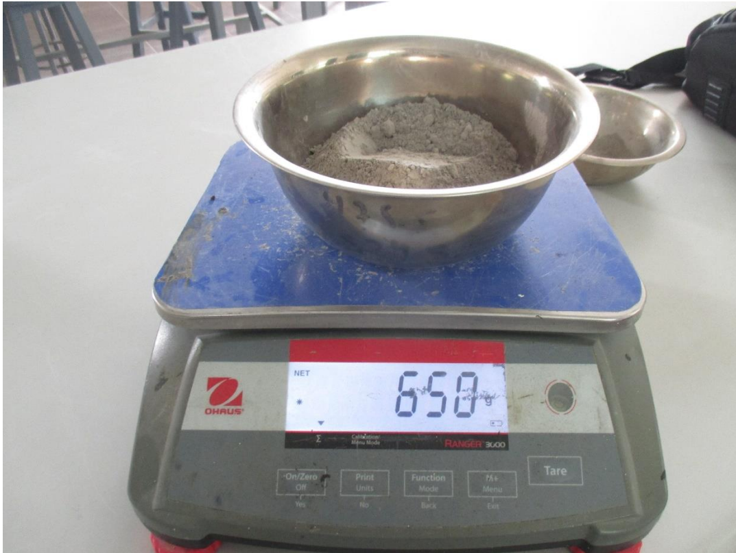
Foto N° 05: Peso de la muestra de cemento para el ensayo de consistencia
