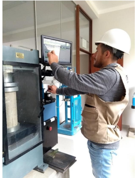
Foto N° 19: Rotura de testigos cilíndricos
