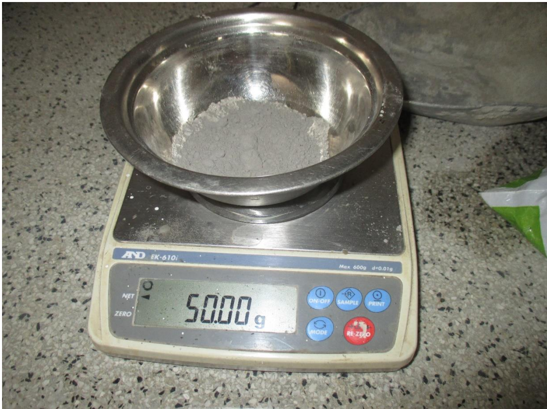
Foto N° 01: Peso de la muestra de cemento para el ensayo de finura, malla N°200
