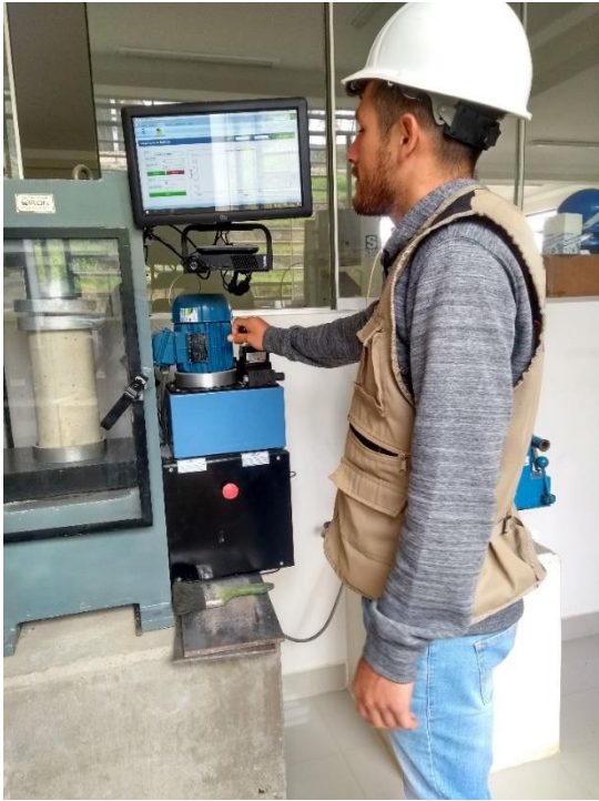
Foto N° 18: Maquina de ensayos universal
