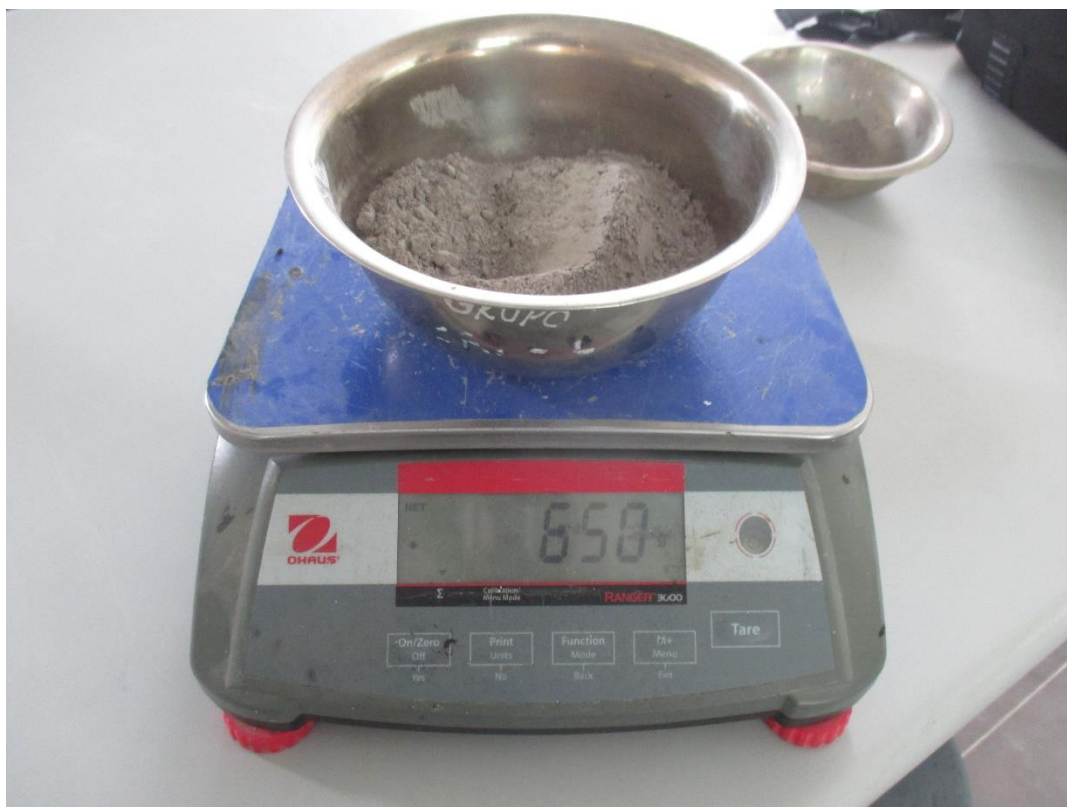
Foto N° 11: Peso de la muestra de cemento para el ensayo de tiempo de fraguado
