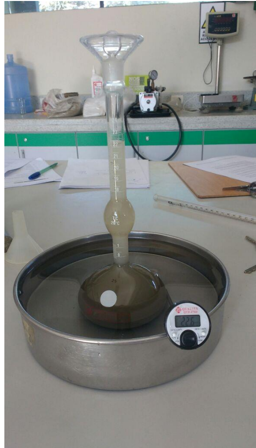
Foto N° 17: Baño de agua
