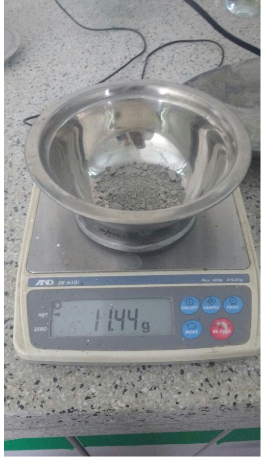
Foto N° 04: Peso de la Muestra retenida Tamiz N°200
