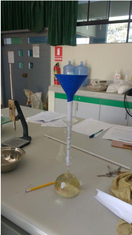
Foto N° 16: Frasco de Le Chatelier con kerosene
