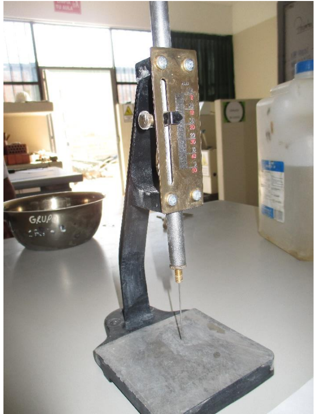
Foto N° 10: Equipo de Vicat (aguja de Vicat)
