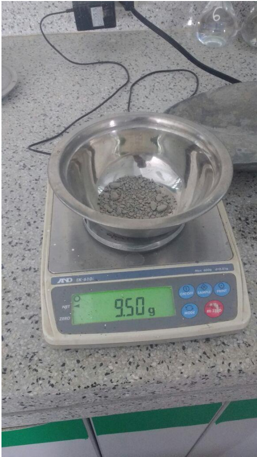
Foto N° 03: Peso de la muestra retenida Tamiz N°200
