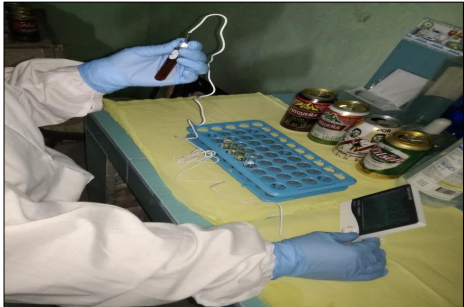
Figura 21: Medición del pH de las bebidas utilizando un pHmetro
