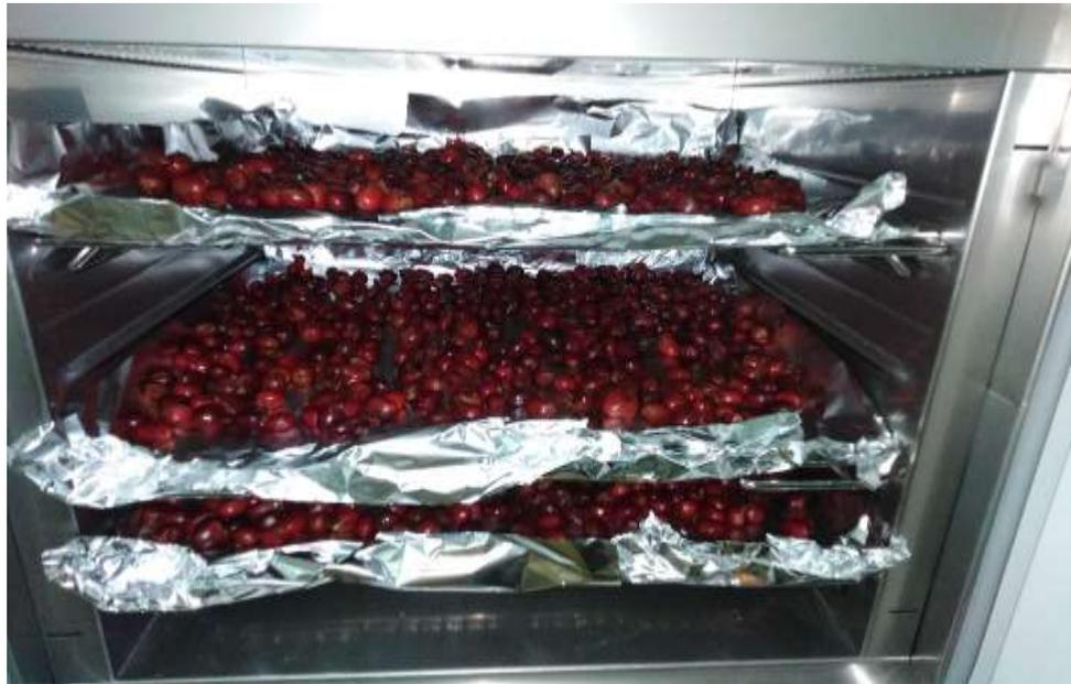
*Figura 4. Equipo estufa para el secado de la pulpa de café.*
