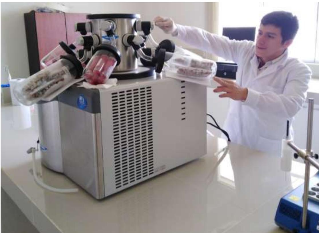
*Figura 23. Deshidratación de la pulpa de café mediante el proceso de liofilizado*
