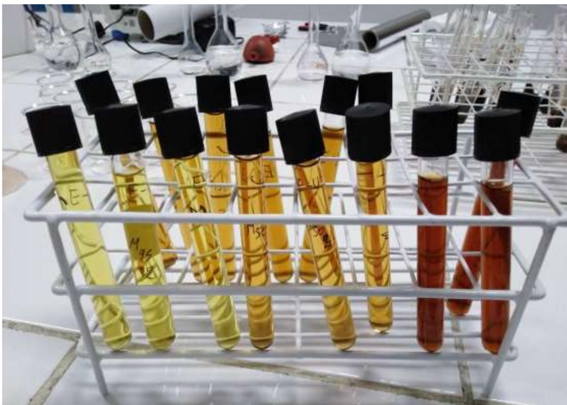
**Figura 29.** Obtención de los extractos de las muestras de pulpa de café deshidratada
