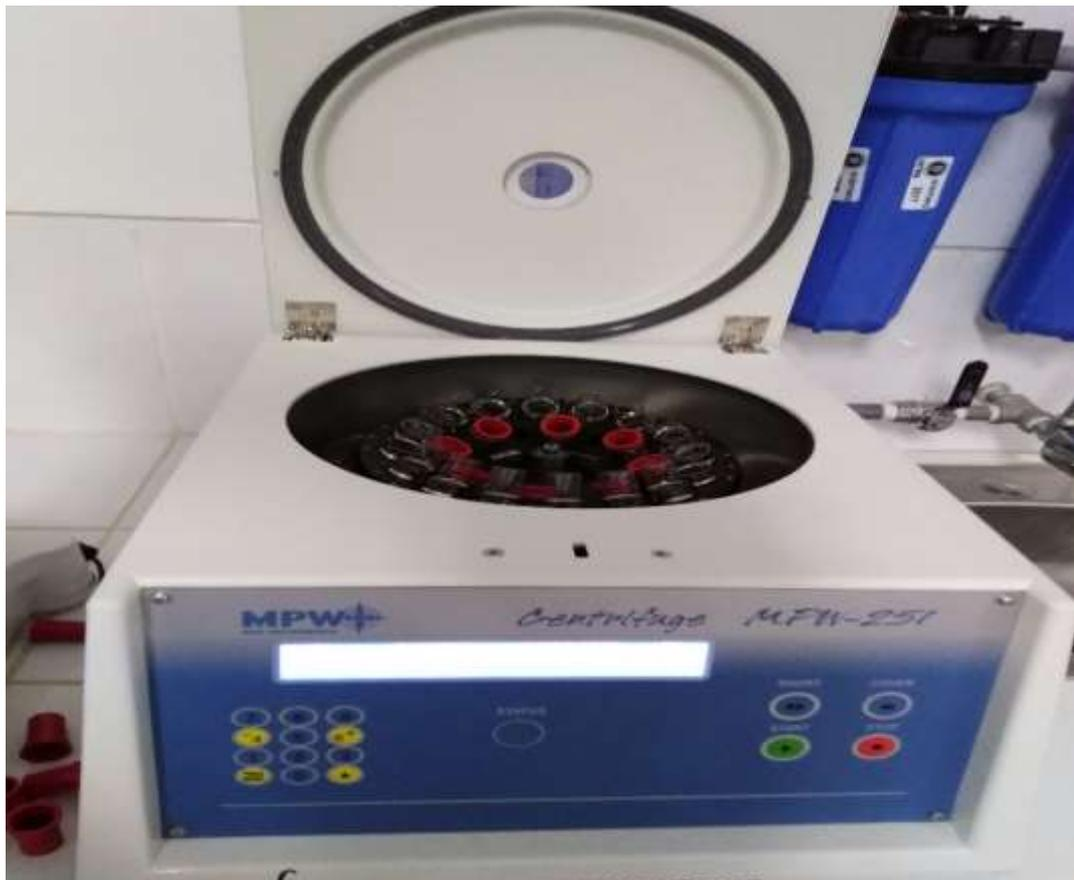
**Figura 27.** *Equipo centrifuga contenido de muestras de pulpa de café y solvente*
