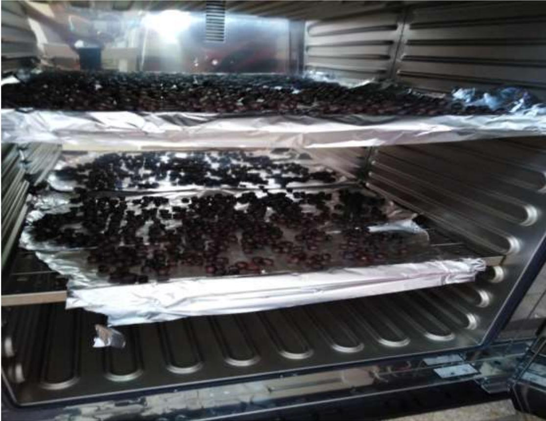
*Figura 22. Deshidratación de la pulpa de café mediante aire caliente (equipo de estufa)*
