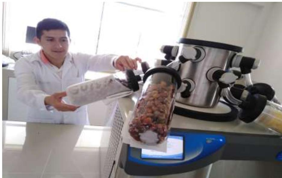
**Figura 5.** Equipo de liofilizado para la liofilización de la pulpa de café.
