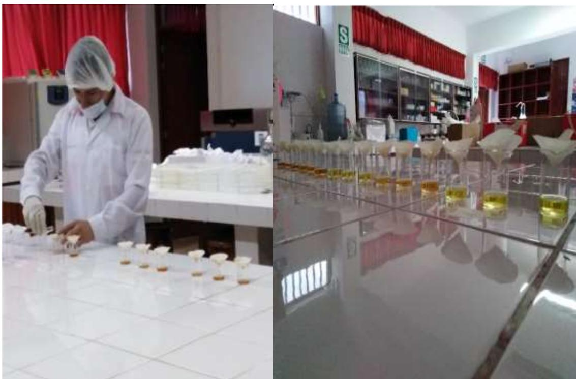
**Figura 28.** Proceso de filtración de los extractos de las muestras de pulpa de café deshidratada
