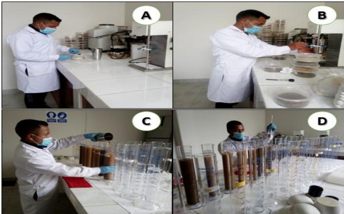
**Figura N° 19. "Determinación de la Textura". A): Medición de la muestra. B): Agitado de la muestra. C): Aforo de la muestra a las probetas. D): Medición de las lecturas.**
