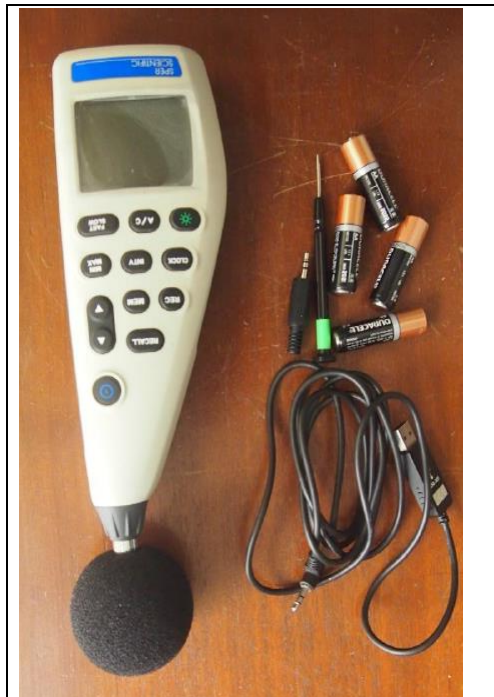
Figura 12: Sonómetro marca SPER SCIENTIFIC, modelo 850013, Tipo II, empleado para recolectar los datos de presión sonora de cada punto de monitoreo.
