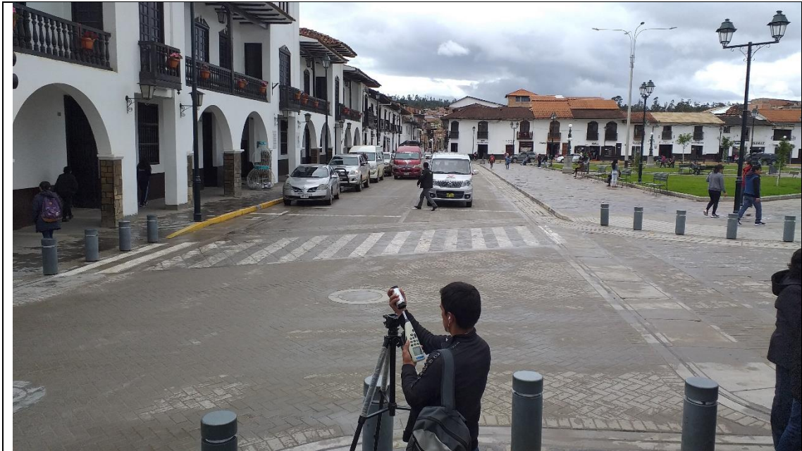
Figura 13: Instalación y calibración del sonómetro para la evaluación de la presión sonora en el P 18 , ubicado en el Jr. Amazonas y Ortiz Arrieta.
