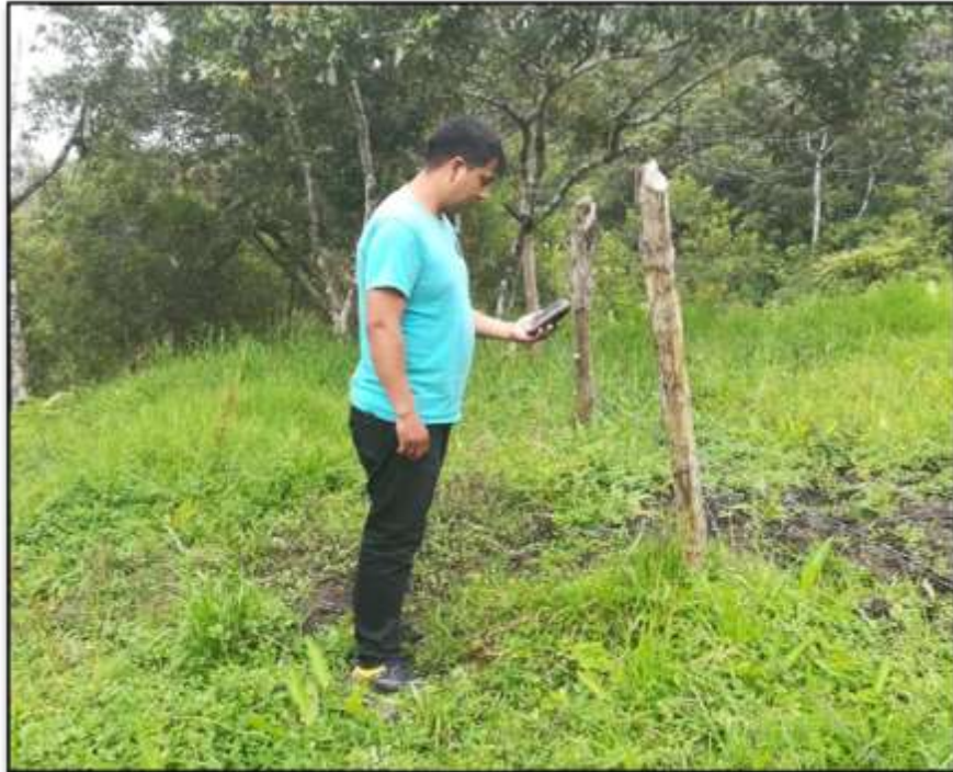
Fotografía 3: Toma de puntos con GPS
