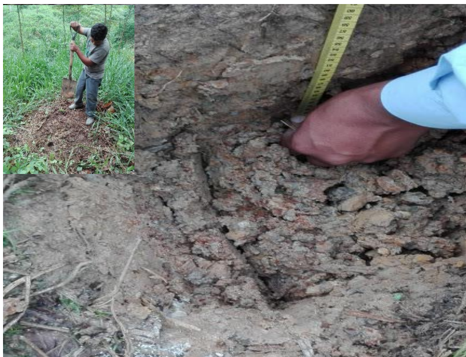
Figura 7. Calicata para la toma de muestra superficial
