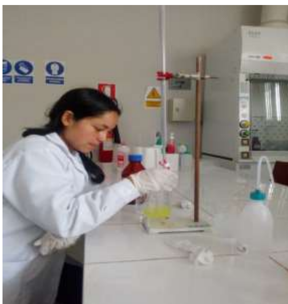
Fotografía 7: Análisis de cloruros en las muestras de agua
