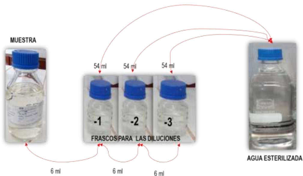
Figura 3. Proceso de dilución de las muestras de agua
