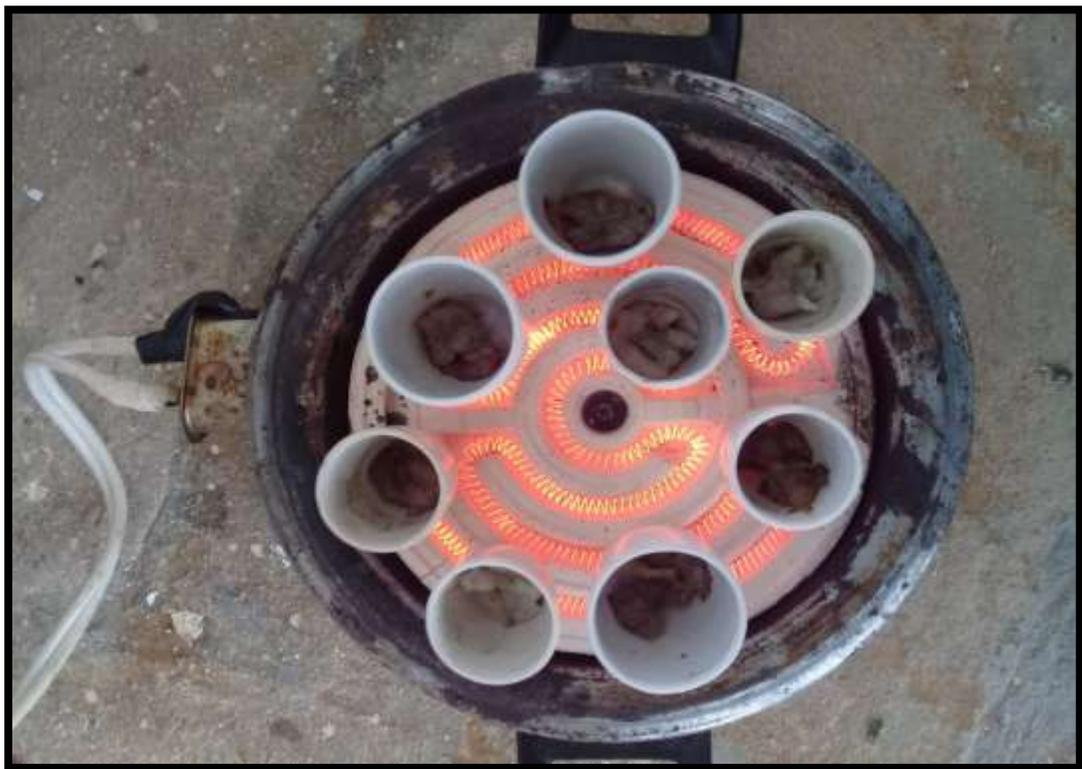
Figura 21. Proceso de incineración para la determinación de cenizas
