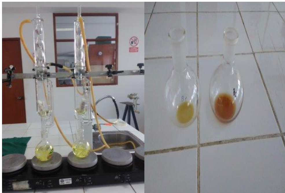
Imagen 9. Determinación de grasa en los insumos (harina de cascara de cacao, harina de pulpa de café, harina de pescado, torta de soya, polvillo de arroz, maíz amarillo, harina de trigo).
