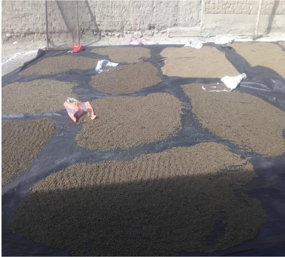
Imagen 16. Secado de los pellets obtenidos.
