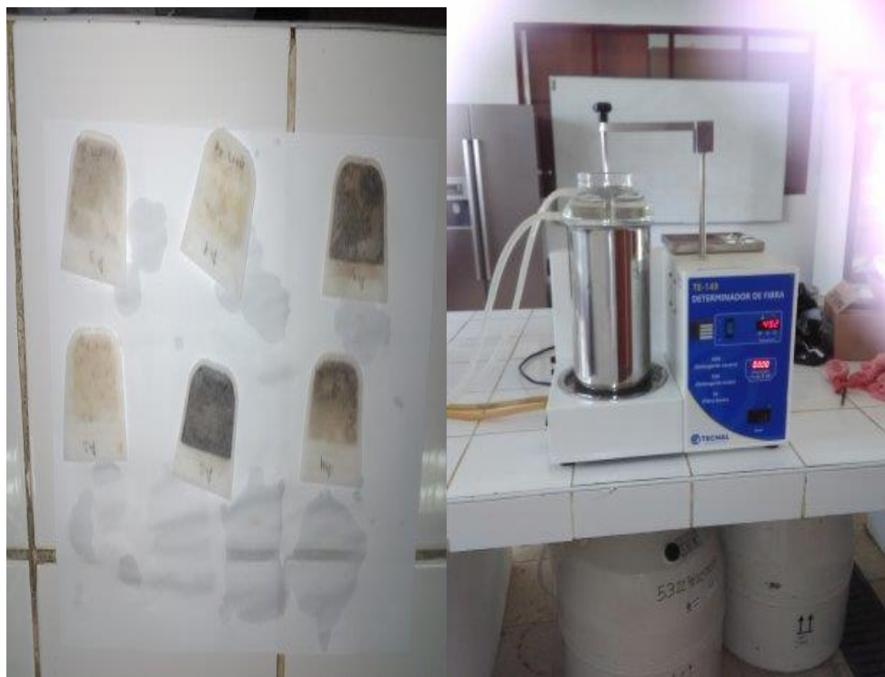
Imagen 8. Determinación de fibra a los insumos (harina de cascara de cacao, harina de pulpa de café, harina de pescado, torta de soya, polvillo de arroz, maíz amarillo, harina de trigo).
