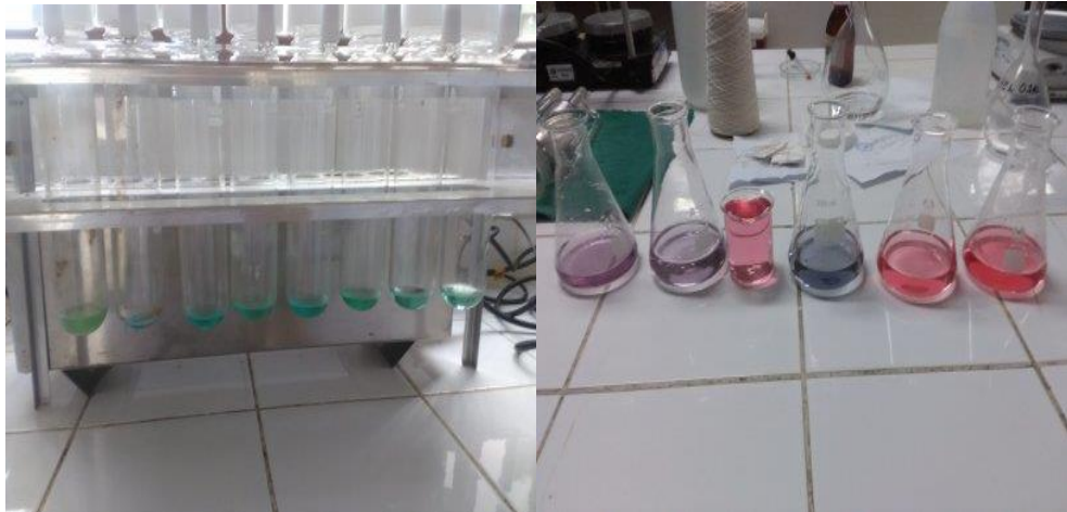
Imagen 10. Determinación de proteína en insumos (harina de cascara de cacao, harina de pulpa de café, harina de pescado, torta de soya, polvillo de arroz, maíz amarillo, harina de trigo).
