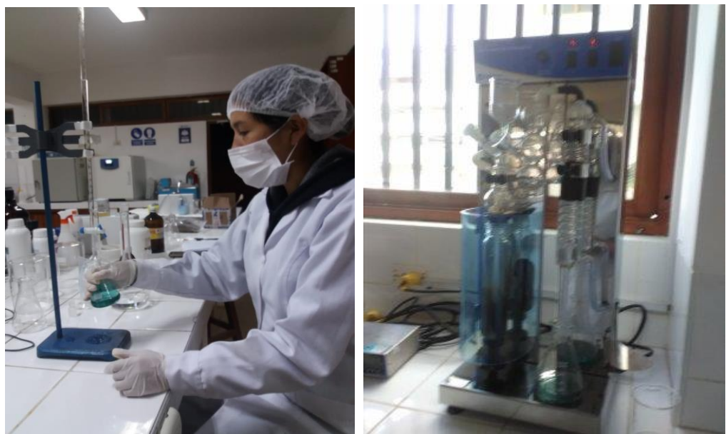
Imagen 21. Titulación en la determinación de proteínas en los pellets.
