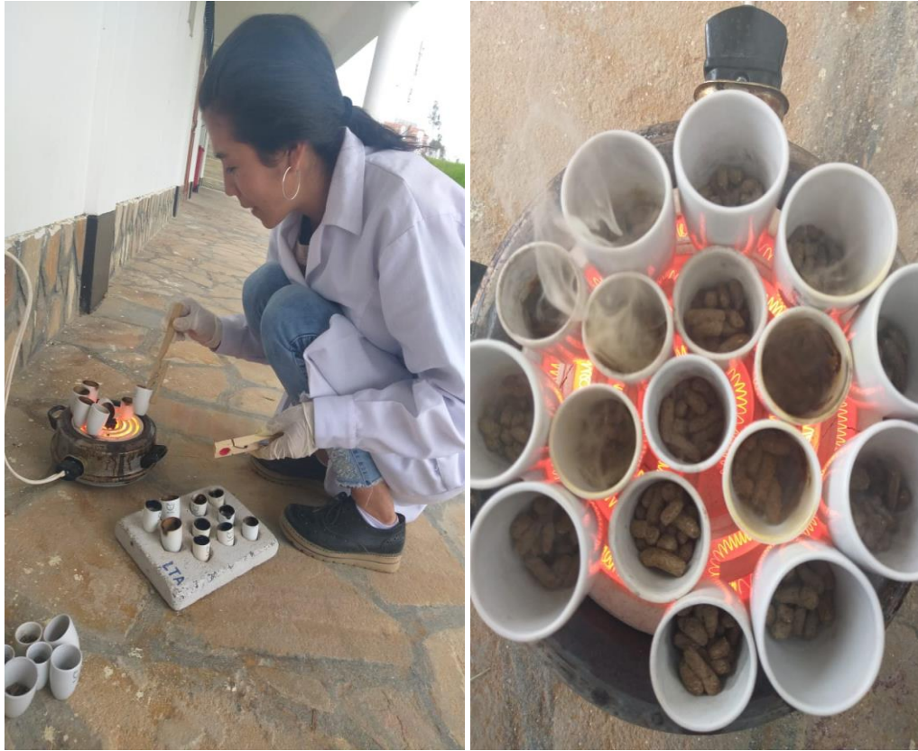
Imagen 18. Determinación del porcentaje de cenizas en los pellets.
