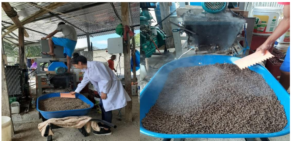
Imagen 12. Elaboración de los pellets en la maquina extrusora.
