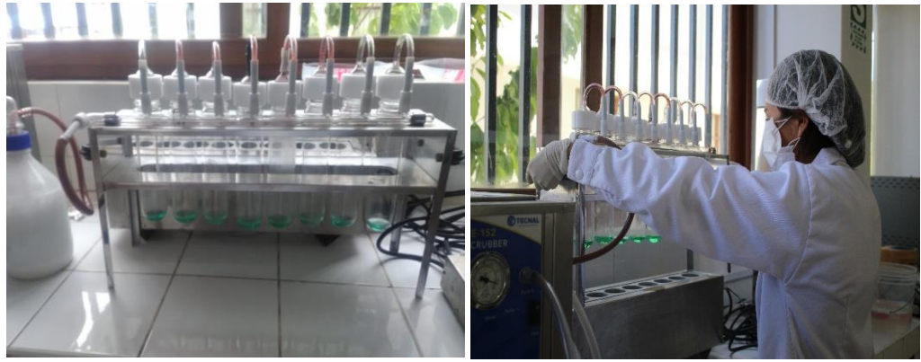
Imagen 20. Preparación de las muestras para la determinación de proteínas en los pellets.
