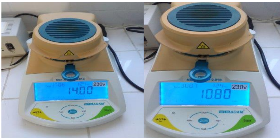
Imagen 7. Determinación de humedad de los insumos.
