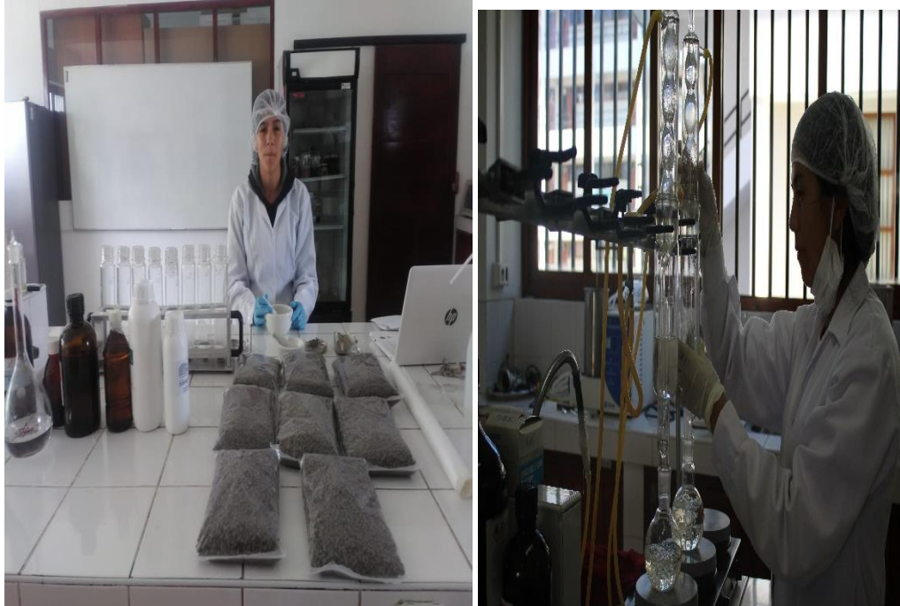
Imagen 19. Determinación del porcentaje de grasa en los pellets.
