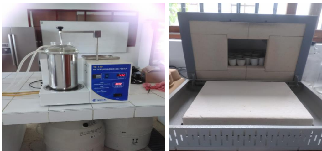
Imagen 22. Determinación del porcentaje de fibra en los pellets.
