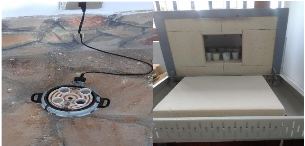
Imagen 11. Determinación de cenizas en insumos (harina de cascara de cacao, harina de pulpa de café, harina de pescado, torta de soya, polvillo de arroz, maíz amarillo, harina de trigo).
