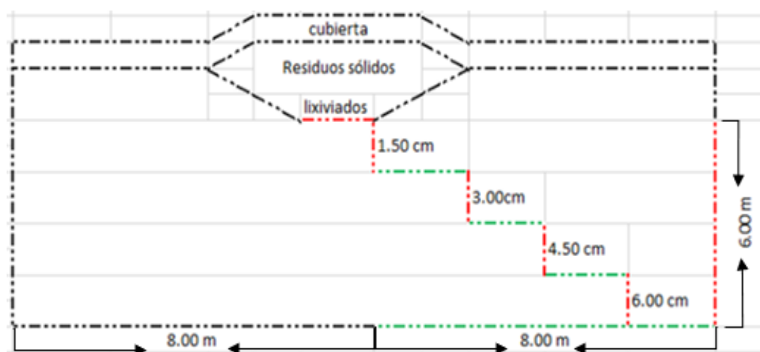
Figura 4. Perfil de la calicata en la obtención de las muestras de suelos
