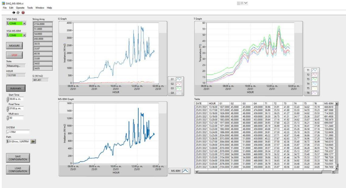
Figura 5. Interfaz del software de LabVIEW de los registros de los datos eléctricos de los sistemas fotovoltaicos
