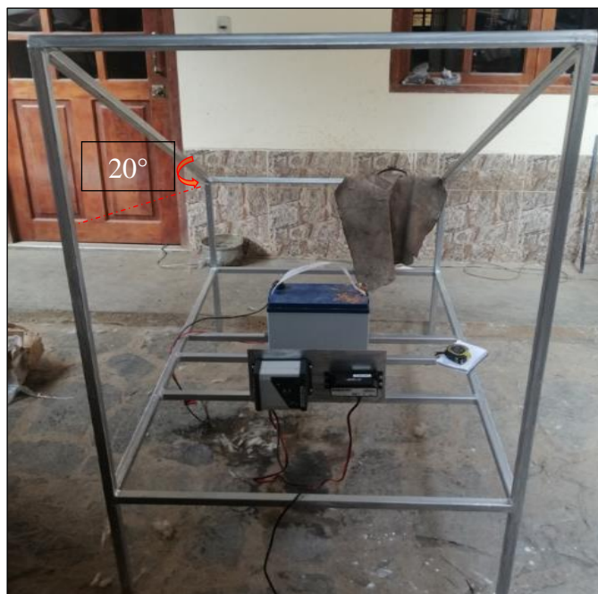
Figura 6. Estructura de soporte del sistema estático
