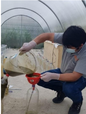
Ilustración 7 Cargando los biodigestores (Caesalpinia spinosa)
