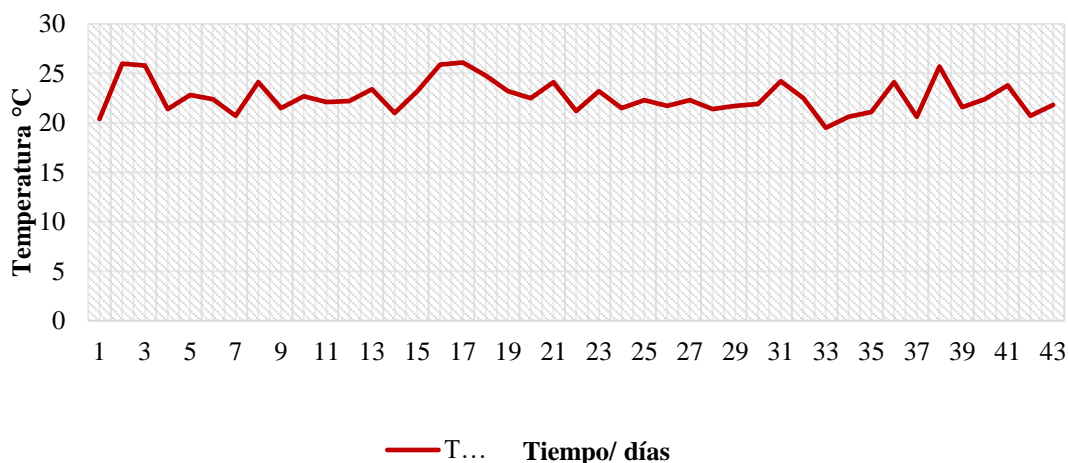
Figura 26 Comportamiento de la temperatura en la producción de biogás durante 43 días de evaluación
