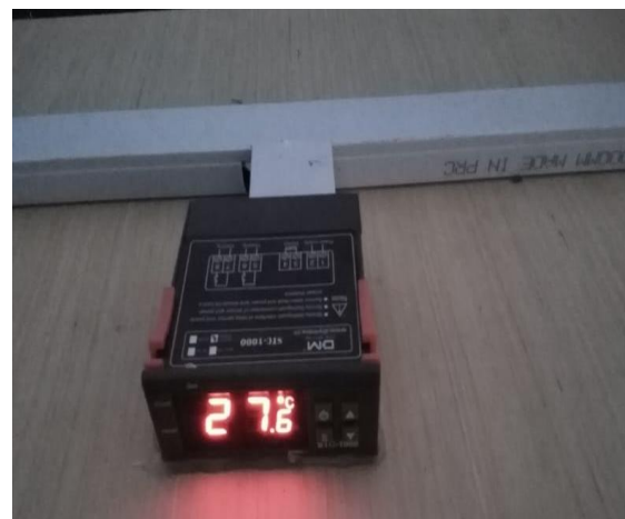
Ilustración 18 Equipo termostato STC-1000
