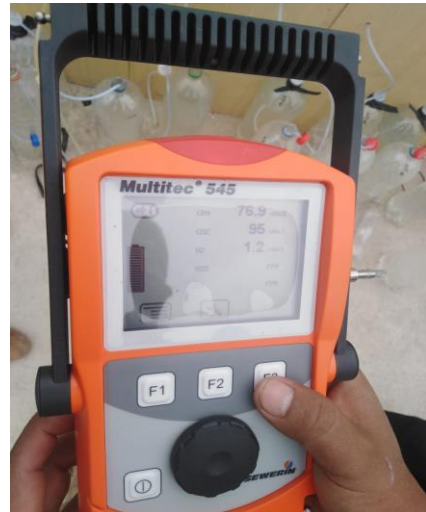
Ilustración 16 Equipo para medir el metano CH 4
