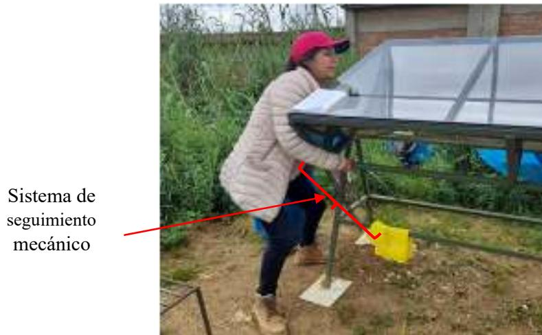
*Nota:* Se muestra el manejo mecánico que se dio al sistema del CCP, dando seguimiento al movimiento del sol
