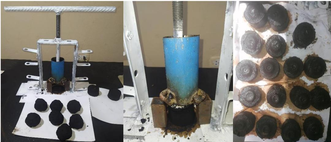
**Figura 10.** Prensa mecánica utilizada para compactación de las briquetas
