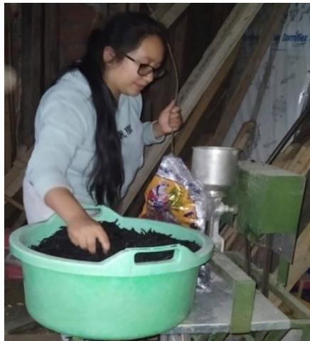
**Figura 6.** Trituración del biochar
