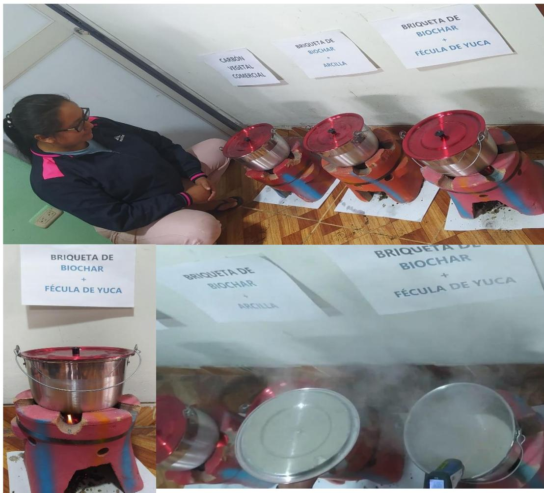
**Figura 17.** Pruebas de ebullición de un litro de agua con los combustibles sólidos
