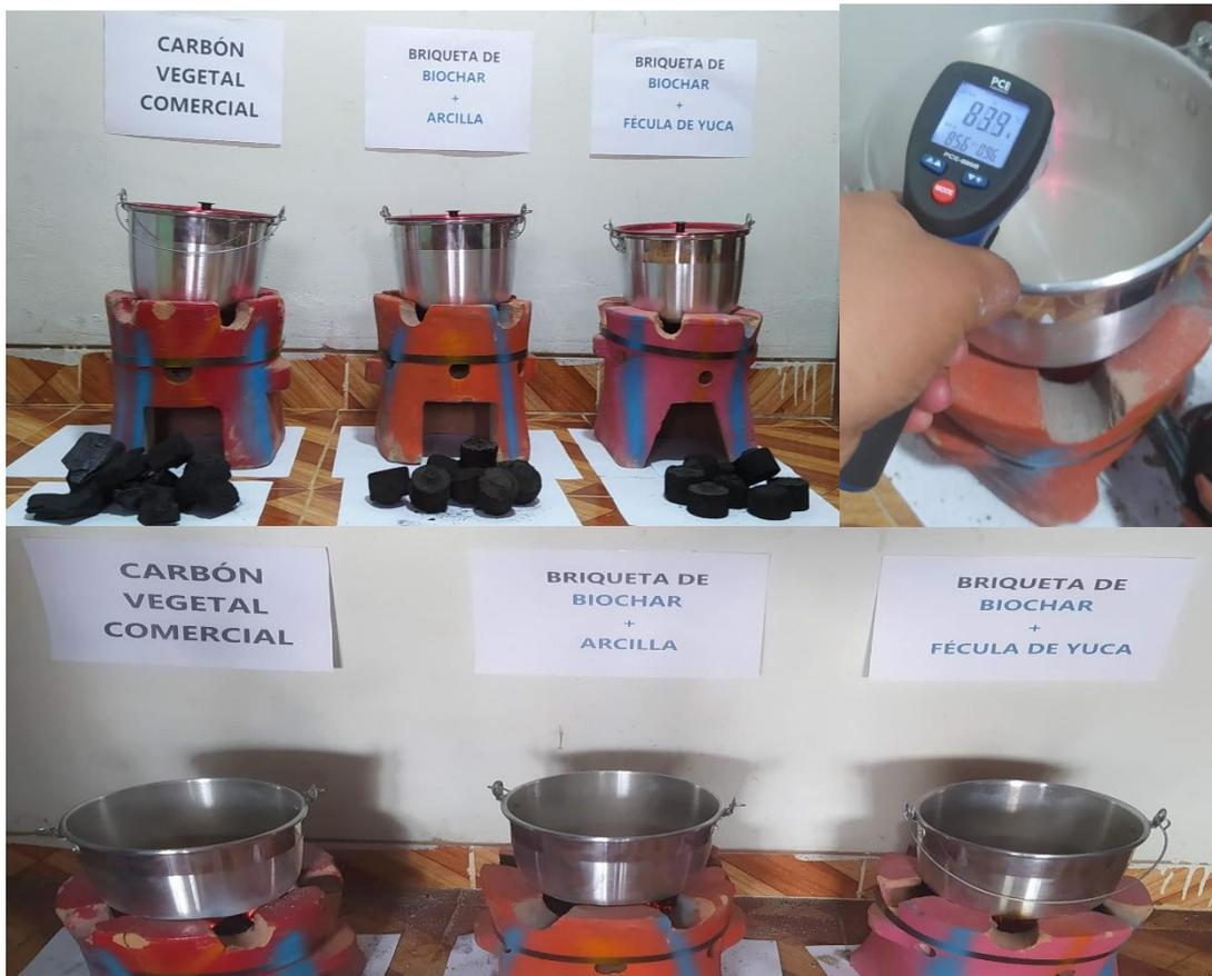
**Figura 12.** Prueba de combustión de los combustibles sólidos
