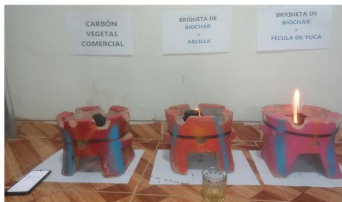
**Figura 11.** Prueba de encendido de los combustibles sólidos
