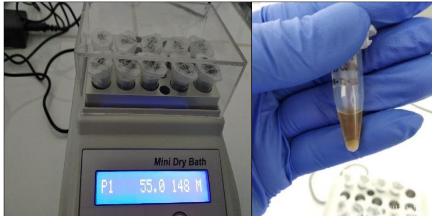
Imagen D. Proceso de digestión de las muestras. A. Incubación de las muestras en el “Mini Dry Bath”. B. Imagen de la muestra digerida.
