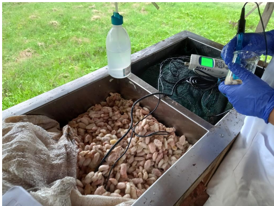
Figura 15. Medición de temperatura, pH y oxígeno disuelto en los granos de cacao durante las primeras horas de fermentación.
