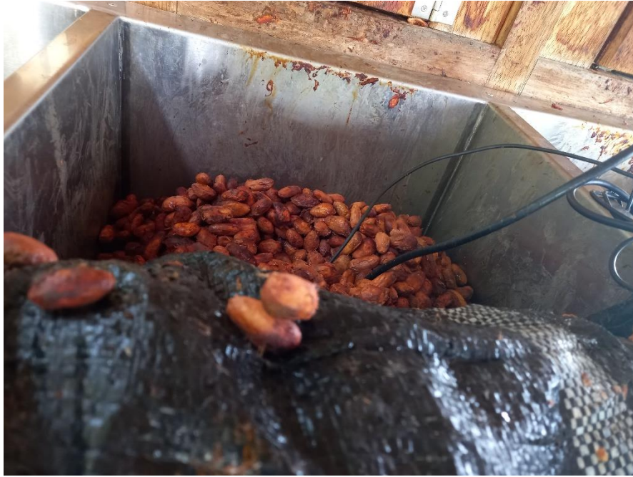
Figura 16. Medición de temperatura, pH y oxígeno disuelto en los granos de cacao durante las últimas horas de fermentación.
