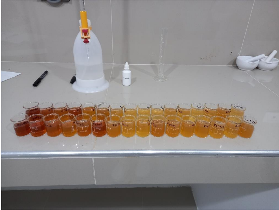
Figura 22. Extractos obtenidos de los granos de cacao fermentados para medir acidez titulable
