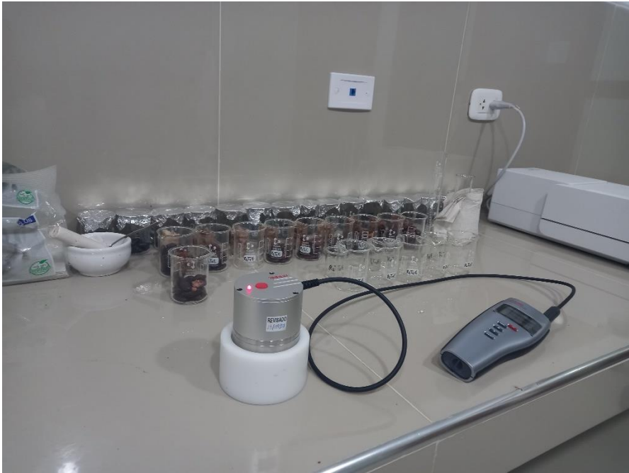
Figura 23. Medición de actividad de agua de los granos de cacao fermentados.
