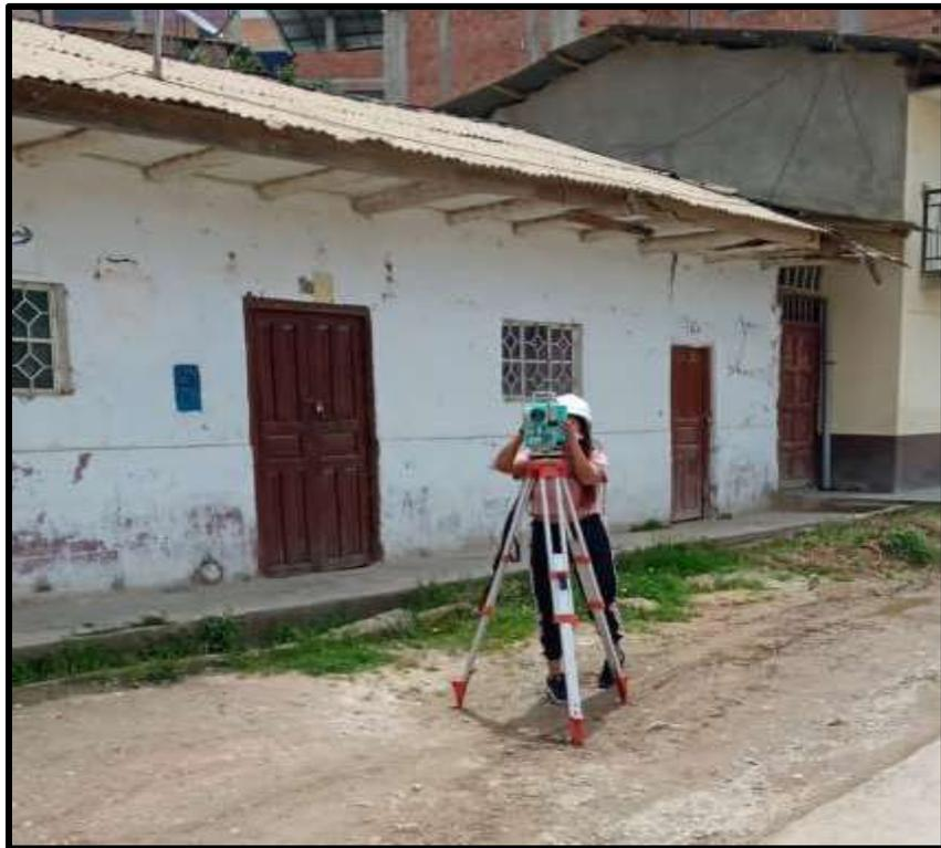
**Foto 07.** Levantamiento topográfico con estación total.
