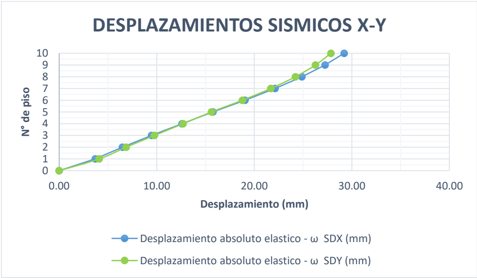
Figura 25. Desplazamiento absoluto elástico de la estructura en la zona sísmica 3 con la implementación de CC
