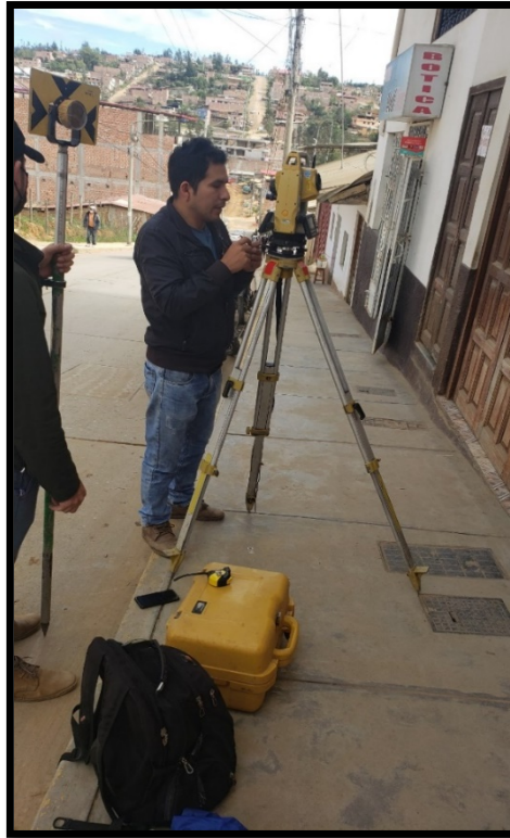
Fotografía N° 11. Puesta en Estación de la Estación Total.
