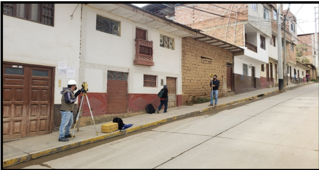
Fotografía N° 12. Toma de puntos topográficos en el Jr. Santa Lucia.
