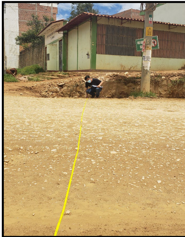
Fotografía N° 8. Toma de medidas de anchos de vía.
