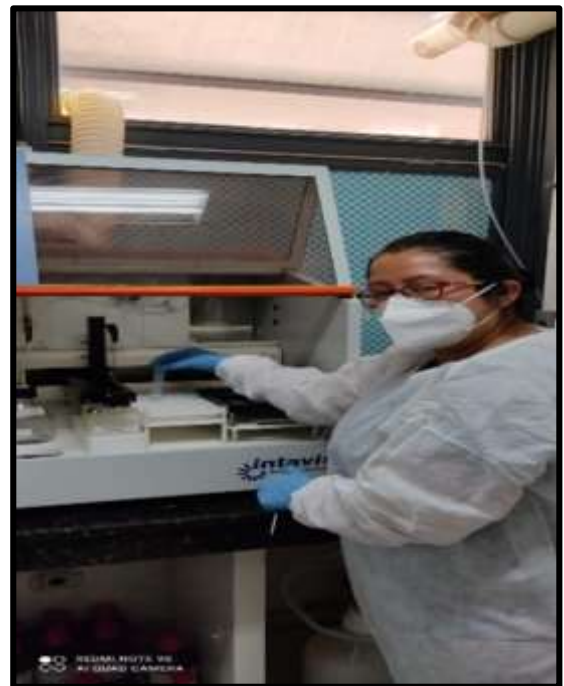
Colocación de la membrana en el Sintetizador para el procedimiento
