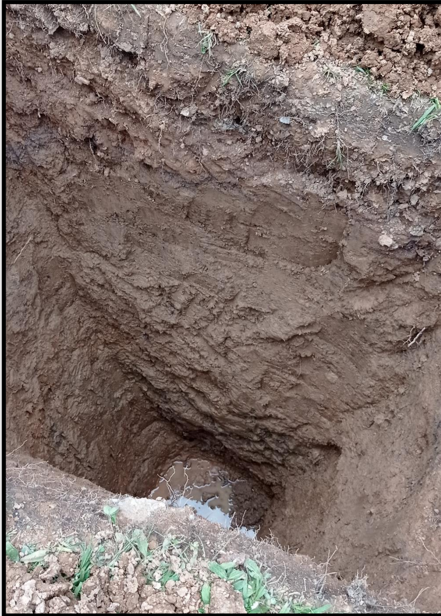
Fotografía N° 5. Presencia de agua en la calicata (C-1), el nivel freático se encontró a los 80 cm de profundidad.
