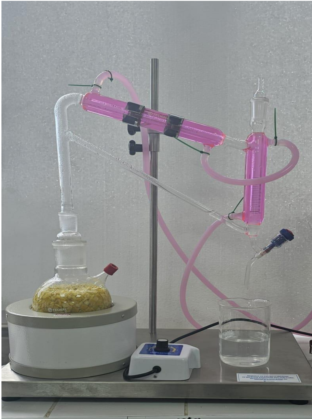
Figura 10. Proceso de extracción de las pieles de los cuatro cítricos
