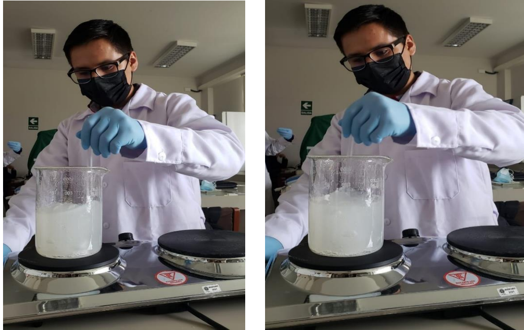
Figura 4. Preparación del almidón, glicerol y alcohol polivinílico para la película bioactiva
