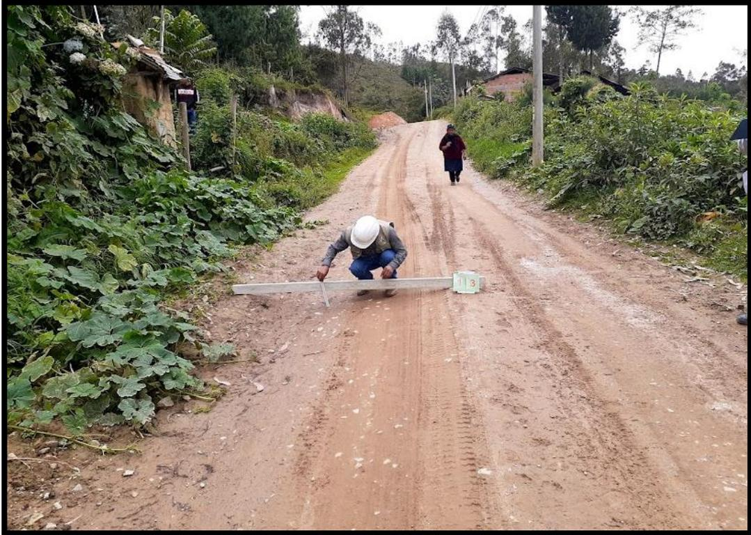
**Figura 21.** Deformación gravedad 3: Profundidad 12.40 cm, en el Km 19+240.
