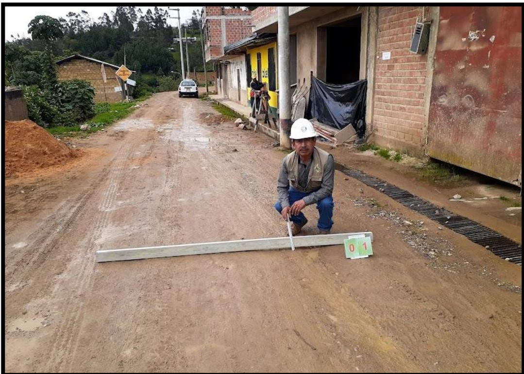
**Figura 22.** Deformación gravedad 1: Profundidad 3.00 cm, en el Km 20+680
