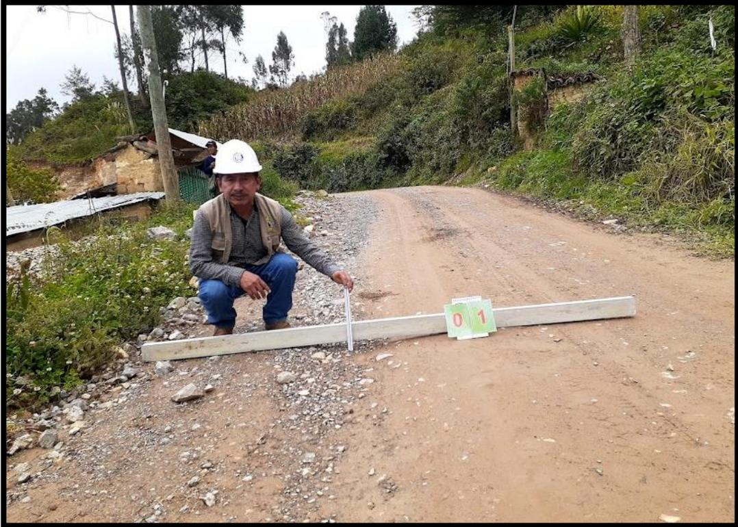
**Figura 27.** Deformación gravedad 1: Profundidad 4.40 cm, en el Km 20+600
