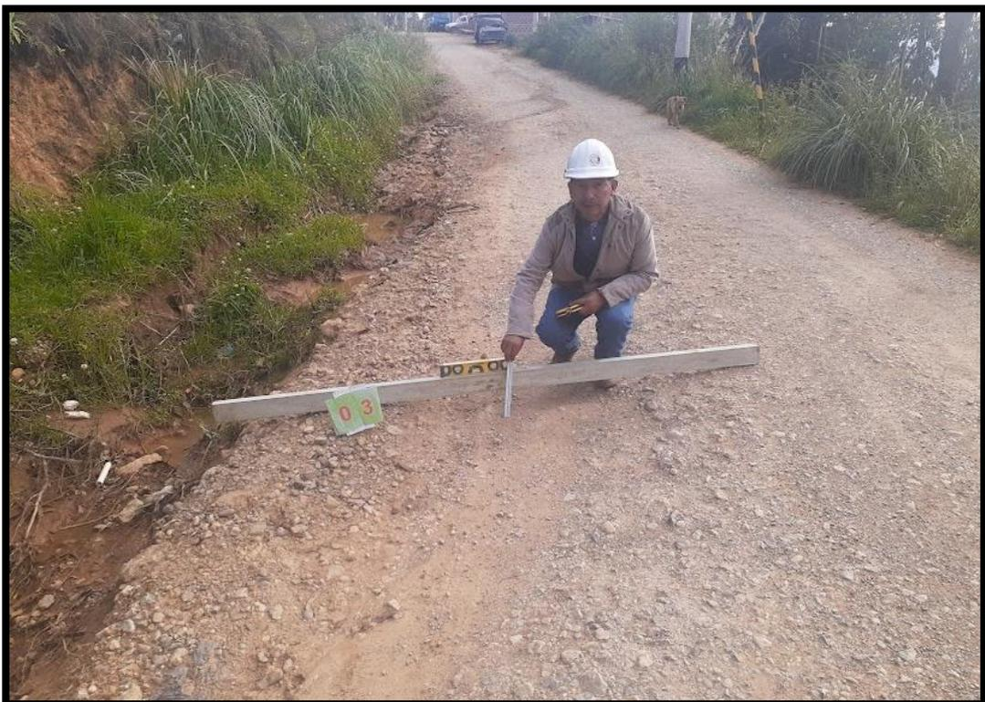
**Figura 20.** Deformación gravedad 2: Profundidad 8.50 cm, en el Km 0+450.
