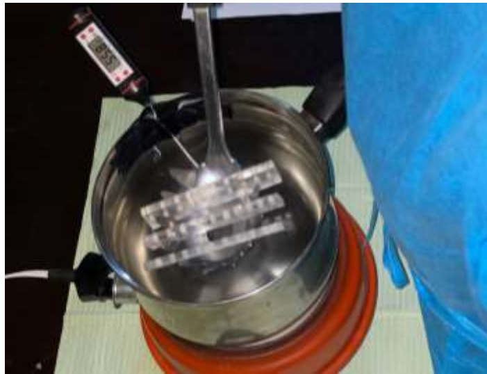
Imagen N° 17: Recipiente de agua, al cual se le agrego cubos de hielo, con un rango temperatura de entre 5° a 8° para el procedimiento de envejecimiento artificial acelerado.
