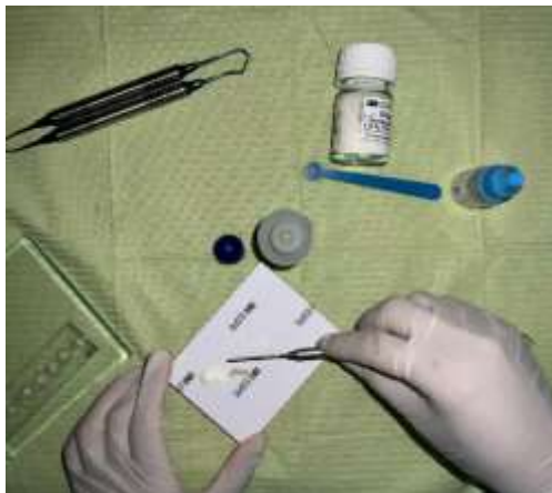
Imagen N° 12: colocación de la mezcla en el cilindro de la probeta.
