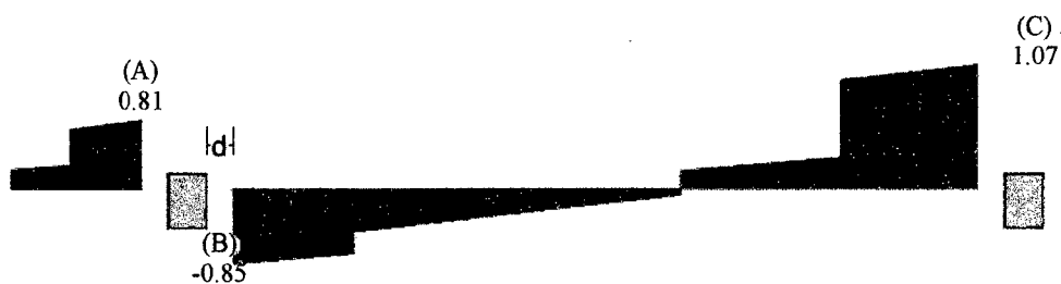
Figura 61. Momentos flectores para la viga CH (0.25x0.20m) (ton-m).
