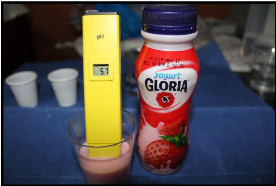
PHmetro con la bebida envasada yogurt gloria que marca un pH de 5.7
