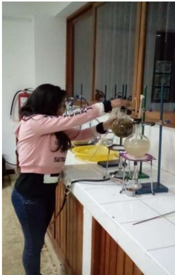
Figura 61. Destilacion del aceite esencial
