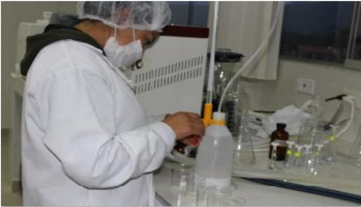
Fotografía 4. Determinación de acidez titulable por el método volumétrico
