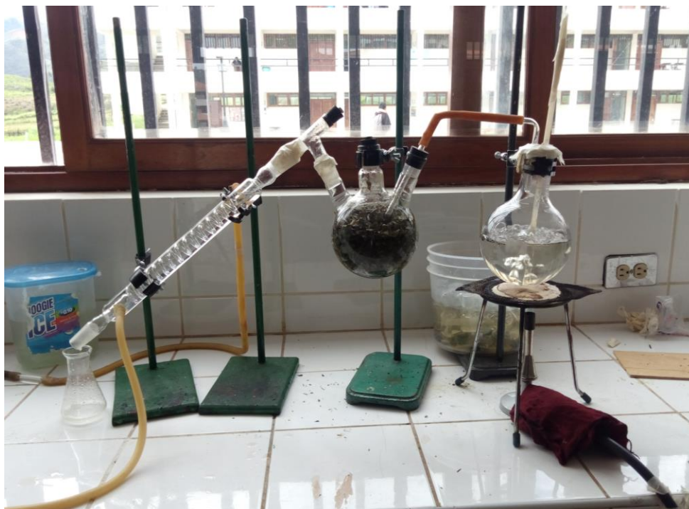
Figura 3. Fotografía de la extracción de arrastre de vapor.
