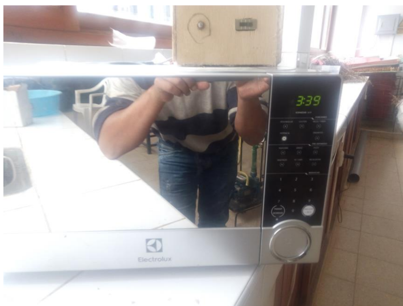
Figura 5. Fotografía de pretratamiento (6 minutos) en microondas para hidrodestilación asistida.
