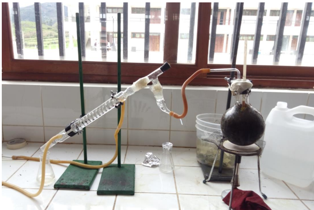
Figura 4. Extracción por hidrodestilación.
