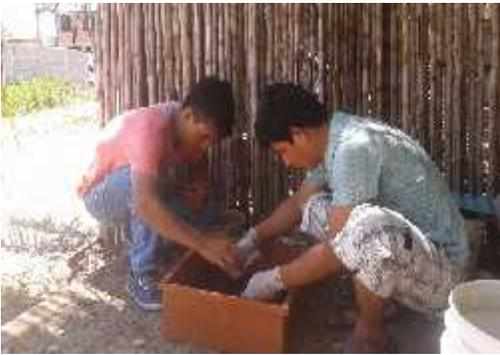
Fotografía 3. Mesclado de aserrín, tierra y agua residual para la adaptación
