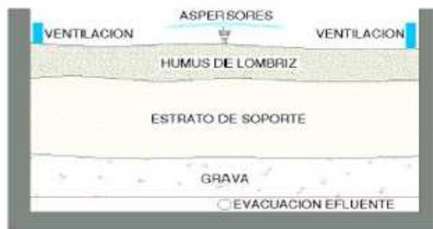
**Fig. 1:** Capas del Lombrifiltro
