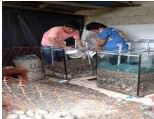
Fotografía 12. Llenado de las capas del lombrifiltro
