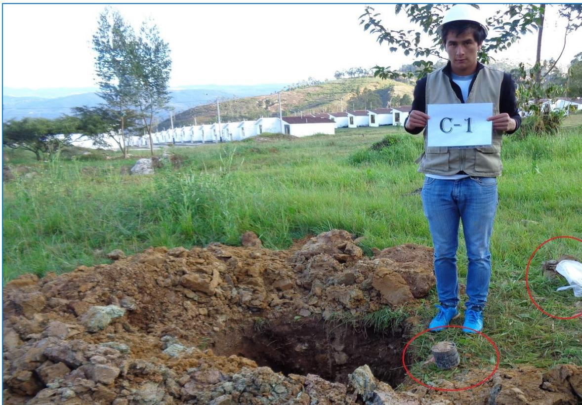
Foto N° 06. Obtención de muestra inalterada, Calicata N° 02.
