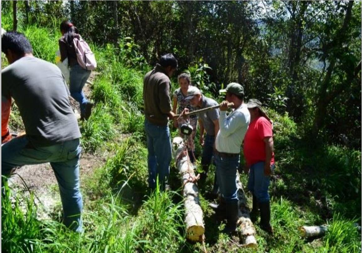
Imagen 06: Cortes de secciones de 5 centímetros del tronco de 2 metros.
