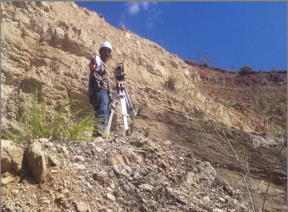
**FOTO 03 y 04.** Levantamiento topográfico del talud con estación total.
