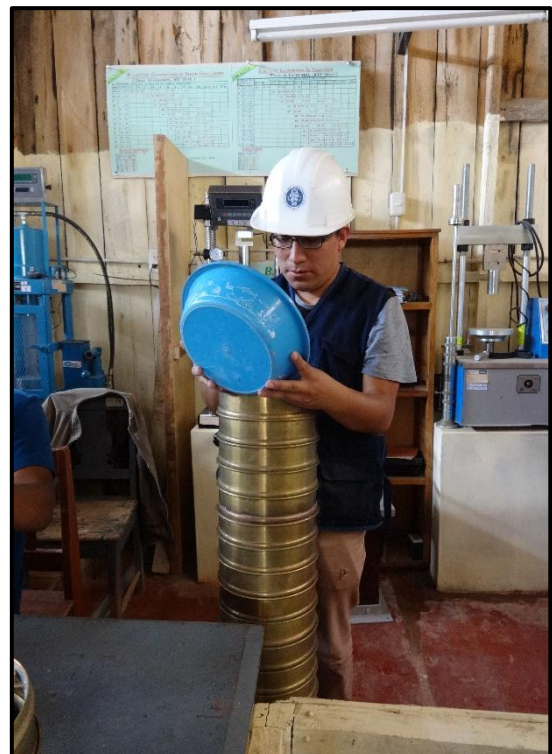
FOTO N° 18. Análisis granulométrico manualmente.
