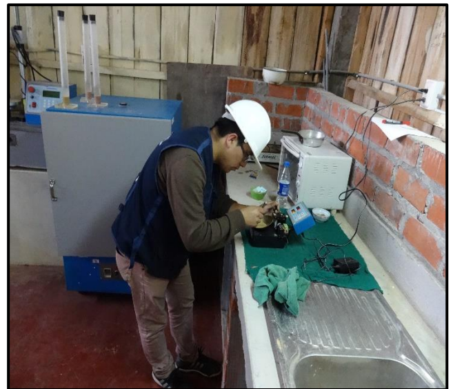
FOTO N° 22. Realizando el ensayo de Limite Liquido en la Cazuela de Casagrande.
