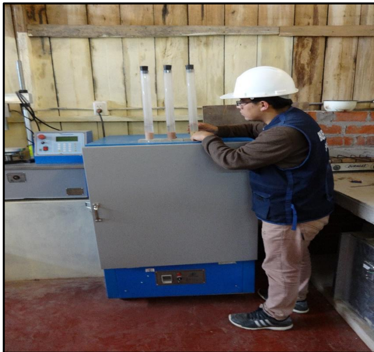
FOTO N° 24. Ensayo de expansibilidad del suelo con probetas.
