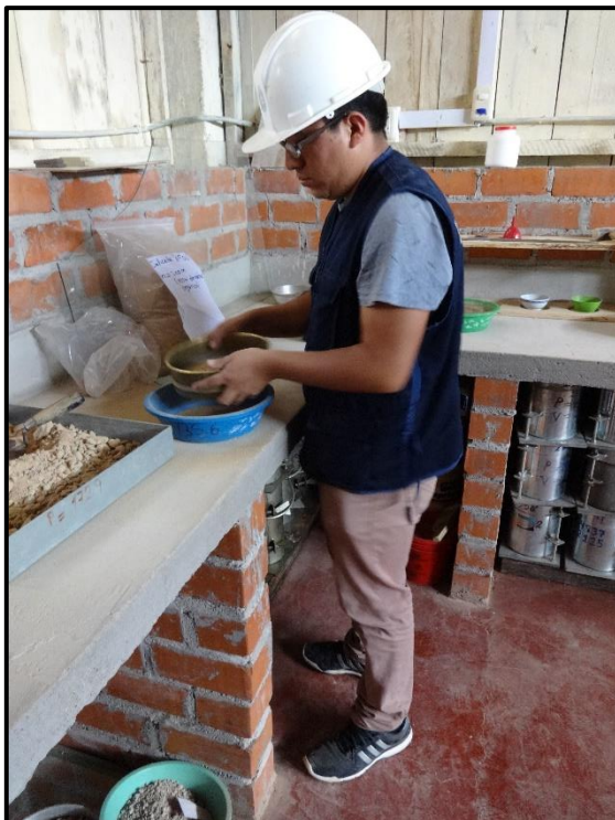
FOTO N° 17. Zarandeo del material con la malla N° 04, para el ensayo de granulometría.
