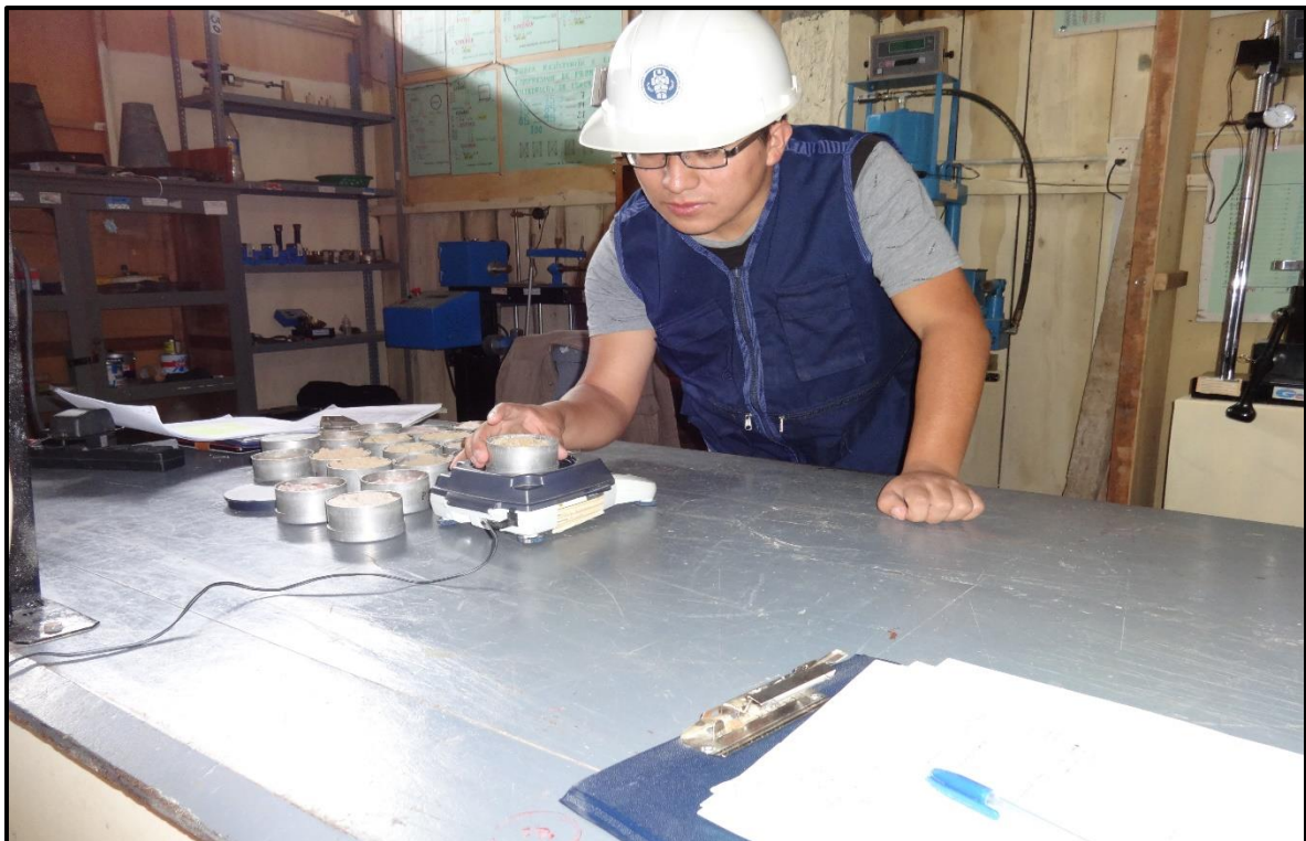
FOTO N° 14. Registro del peso para el contenido de humedad.
