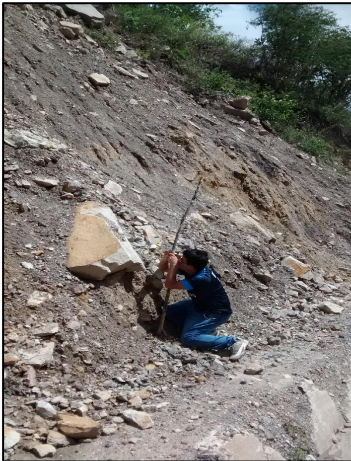
FOTO N°04. Obtención de la pendiente con eclímetro tramo Km 07+500 – km 07+530
