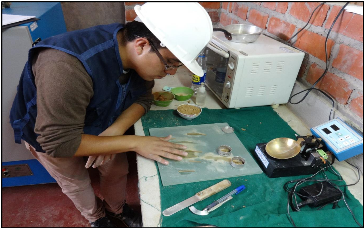
FOTO N° 23. Realizando el ensayo del Limite Plástico
