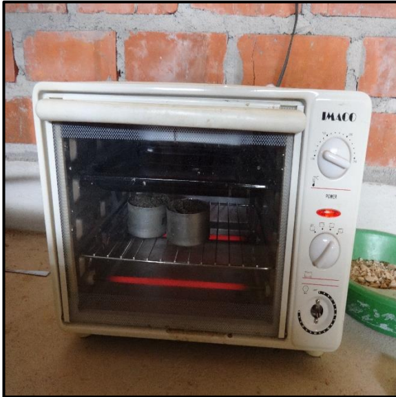
FOTO N° 15. Secado de la muestra para el contenido de humedad.
