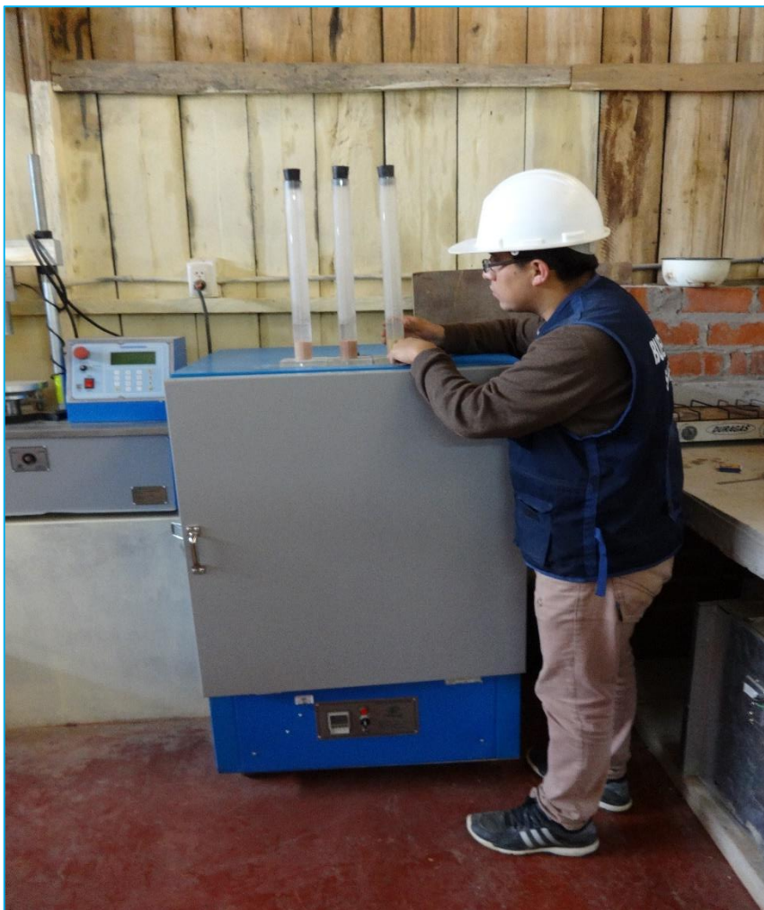
Figura N°14. Ensayo de expansibilidad de suelos según su volumen
