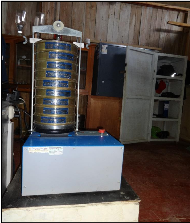
FOTO N° 19. Análisis granulométrico con tamizadora eléctrica.
