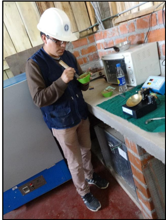
FOTO N° 20. Preparación de la muestra para el Limite Liquido.
