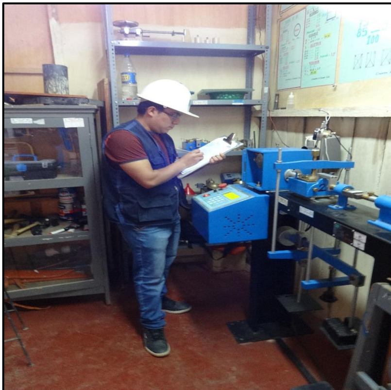
FOTO N° 26. Toma de datos del Ensayo de Corte Directo
