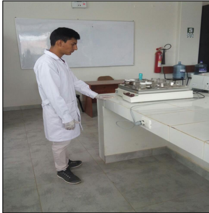
Fotografía 21. Agitación de muestras para medir pH
