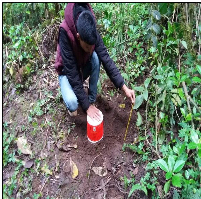
Fotografía 12. Medida de temperatura del suelo del bosque
