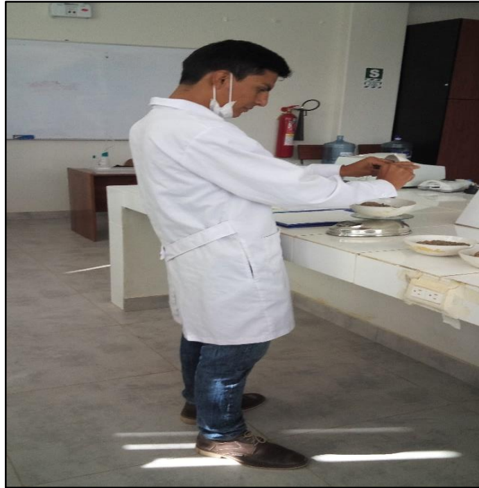
Fotografía 19. Pesado de muestras para densidad aparente
