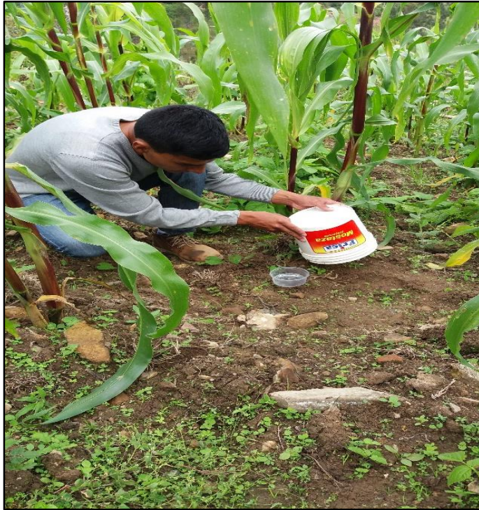
Fotografía 3. Captura de CO 2 del suelo de maíz
