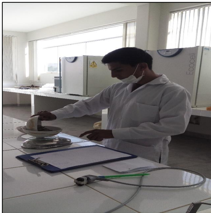
Fotografía 20. Pesado de muestras para humedad
