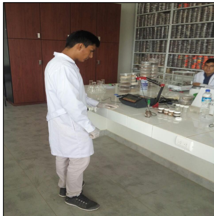
Fotografía 22. Medición de pH del suelo.
