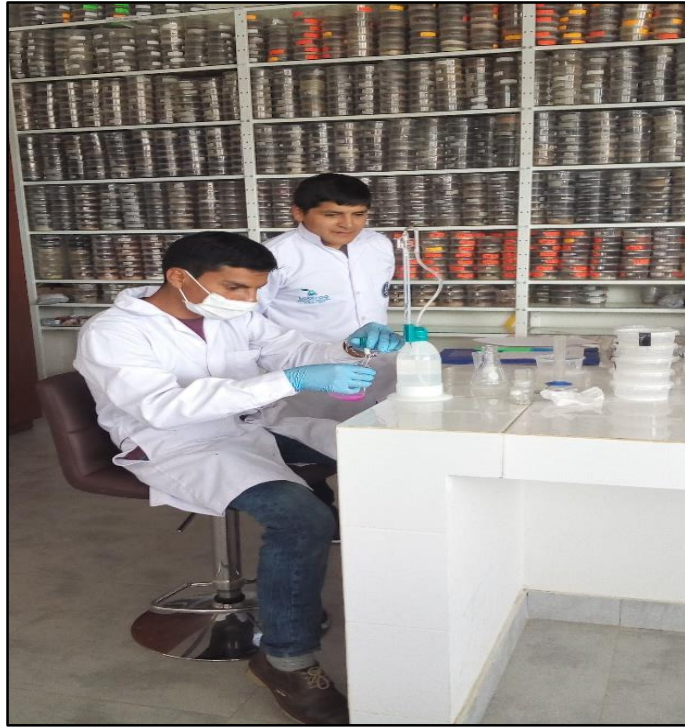
Fotografía 17. Titulación con HCl 0,1N.
