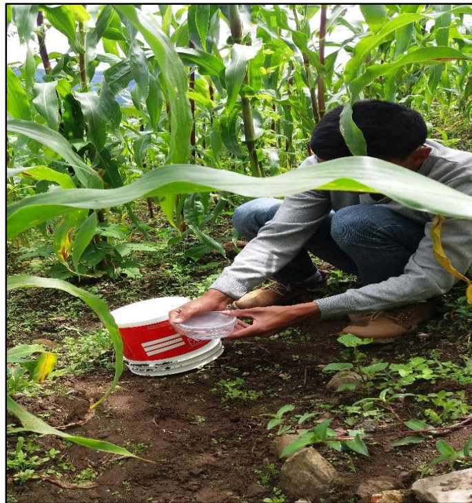
Fotografía 4. Recojo de muestra de CO 2 del suelo de maíz
