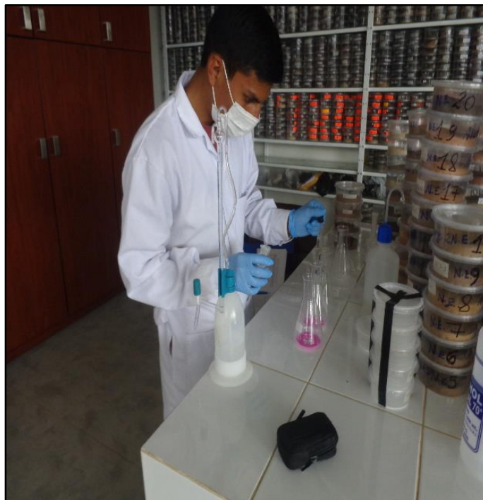
Fotografía 16. Adición de fenolftaleína a la muestra
