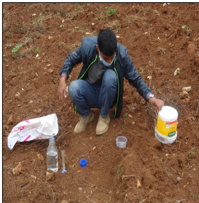
Fotografía 1. Evaluación del volumen gaseoso en suelo de papa.
