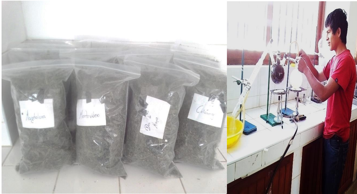
Figura 132. Adecuación de las muestras en el equipo de extracción de arrastre por vapor
