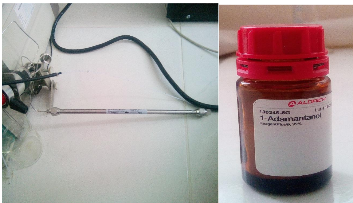
Figura 135. Columna RP-18 endcapped (5 \mu m) N° 702212 y estándar 1-Adamantanol.
