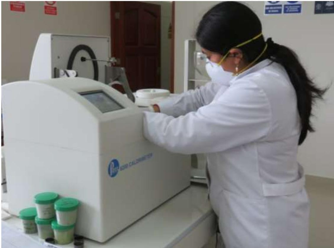
Figura 38. Determinación del análisis de EB mediante la bomba calorimétrica
