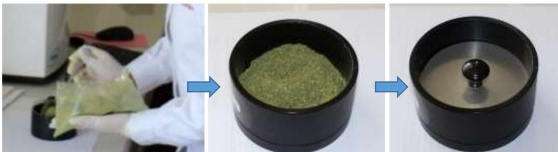
Figura 39. Preparación de la muestra para la toma de espectros en NIR
