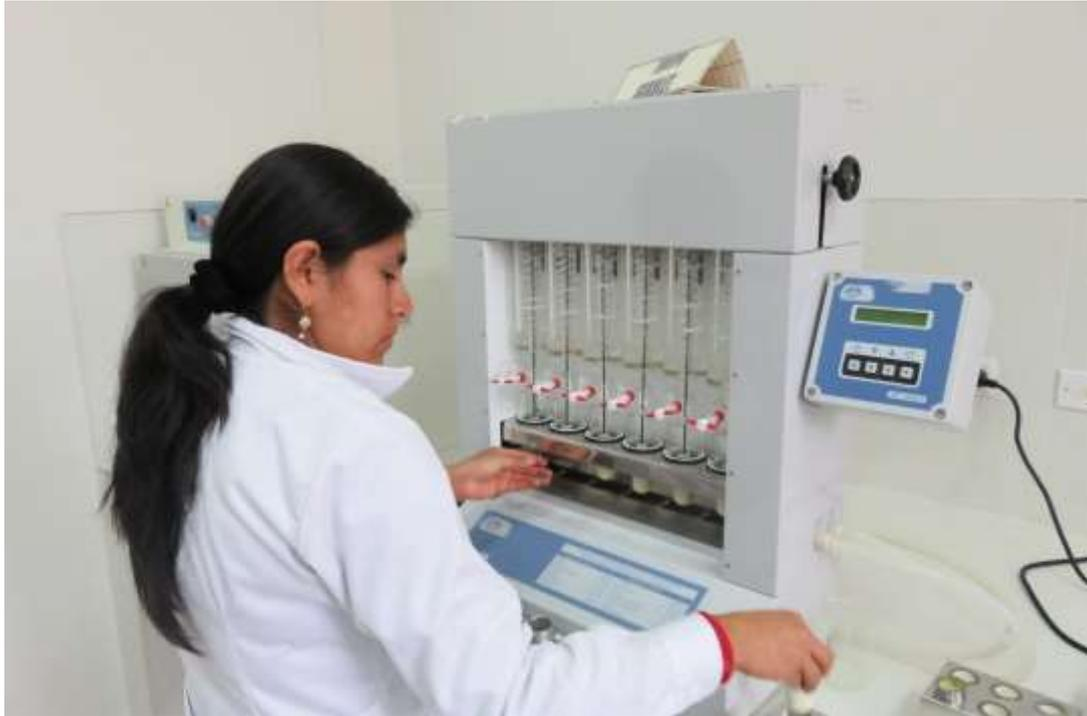
Figura 36. Determinación del análisis de extracto etéreo mediante el equipo Soxhlet
