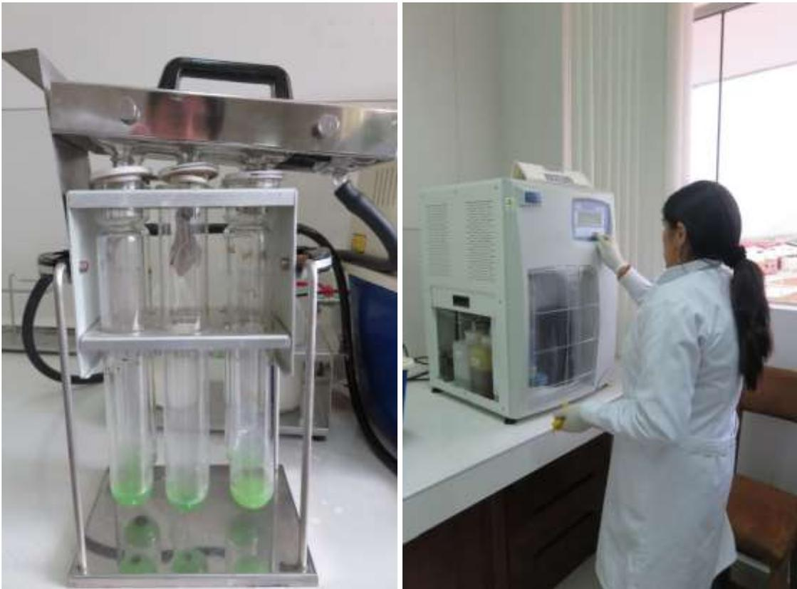
Figura 35. Determinación del análisis de proteína mediante el equipo Kjendal
