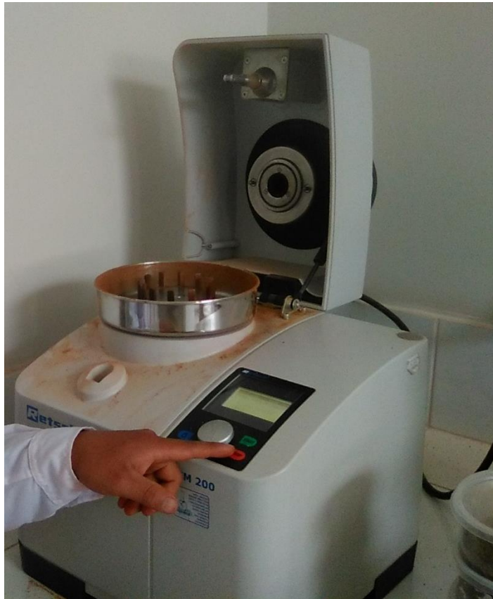
Figura 48. Molino ultracentrífugo (RETSCH ZM200) utilizado para moler las muestras de cáscara de café. Laboratorio de suelos y aguas.
