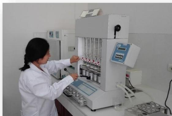
**Figura 11:** Cumpliendo con el proceso de extracción de grasa para determinación del porcentaje de grasa de las muestras, en el Laboratorio de Nutrición Animal y Bromatología de los Alimentos, de la UNTRM.
