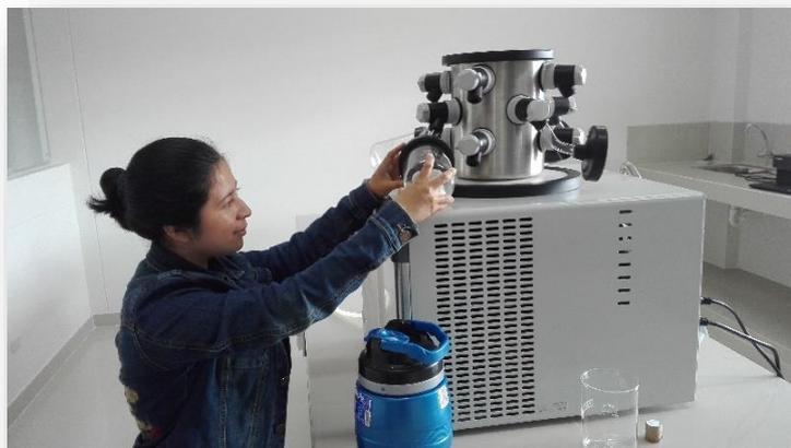
**Figura 13:** Efectuando el proceso de liofilización para las muestras de leche, en el equipo liofilizador Freezone del Laboratorio de Fisiología y Biotecnología Vegetal, de la UNTRM.
