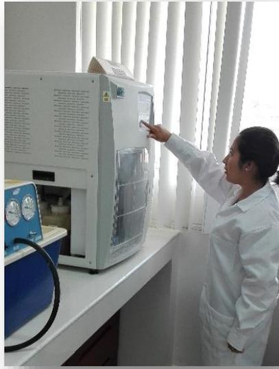
**Figura 12:** Ejecutando el proceso para determinación del porcentaje de proteína de las muestras, mediante equipo Kjeldahl en el Laboratorio de Nutrición Animal y Bromatología de los Alimentos, de la UNTRM.
